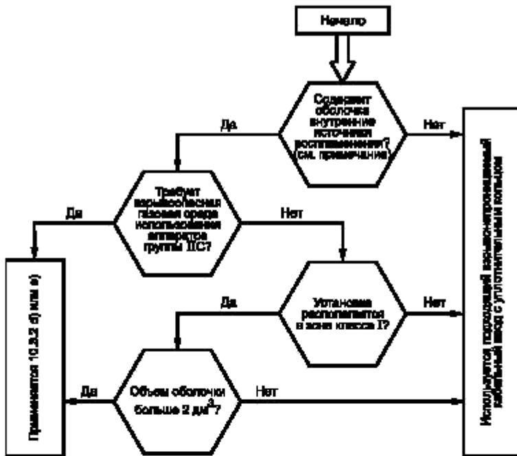
**П р и м е ч а н и е** — Внутренними источниками воспламенения считают искры или нагретые поверхности электрооборудования при его нормальной эксплуатации, которые могут вызвать воспламенение. Оболочку электрооборудования, содержащую только зажимы, или оболочку косвенного ввода (см. 10.3.1) считают не содержащими внутреннего источника воспламенения.
