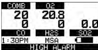
Рис. 6 Условия сигнализации [в данном случае сигнал тревоги верхнего порога срабатывания]
