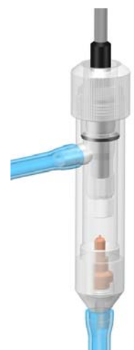
Рис.3.2. Внешний вид сенсора в измерительной камере.
