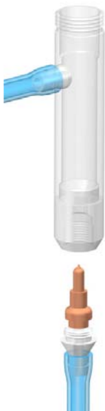
Рис. 4.5. Установка обратного клапана в ИКПЖ
