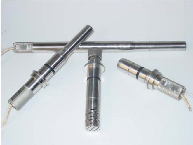
Рис. 3.6. Внешний вид стерилизуемых амперометрических сенсоров АСрО 2 -06.
