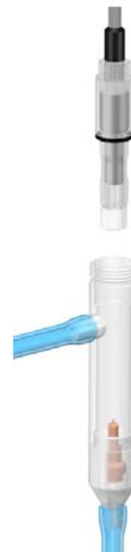
Рис. 3.9. Установка АСрО 2 в измерительную камеру.
