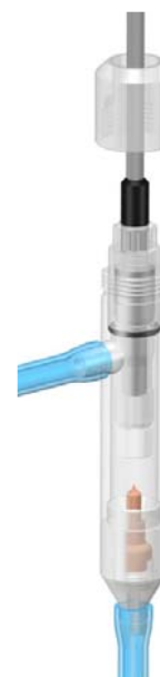
Рис. 3.9. Установка АСрН 2 в измерительную камеру
