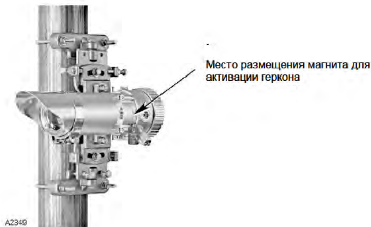
Газоанализатор OPECL, общий вид и место размещения магнита.
