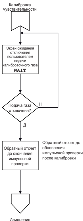
Рис. 13 Импульсная проверка после калибровки для приборов с технологией XCell Pulse
