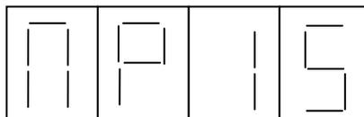
Надпись на дисплее будет изменяться каждую минуту, в течение 15 мин, ведя обратный отсчет окончания прогрева и перехода в основной режим измерения. Режим прогрева сопровождается прерывистым свечением индикаторов единичных "ПОРОГ1" и "ПОРОГ2".
