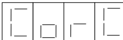
Нажать кнопку "↷" и ввести с помощью кнопок "▽" и "△" значение концентрации ГСО-ПГС № 3, указанное в паспорте на ГСО-ПГС. Для занесения его в память газоанализаторов нажать кнопку "↶", на дисплее индицируется поочередное свечение центральных горизонтальных сегментов. При этом произойдет переход в основное меню.
