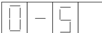
соответствующая выбору выходного токового сигнала 0 – 5 мА. Для выбора выходного токового сигнала 4 – 20 мА нажать любую из кнопок "▷" либо "◁". Для подтверждения выбора нажать кнопку "↵". При этом произойдет переход в основное меню.
