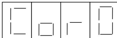
Нажать кнопку "↶" и ввести с помощью кнопок "▽" и "△" значение концентрации ГСО-ПГС № 1. Для занесения его в память газоанализаторов нажать кнопку "↶", на дисплее индицируется поочередное свечение центральных горизонтальных сегментов. При этом произойдет переход в основное меню.
