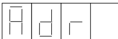
2.3.2.8.2 После появления надписи нажать кнопку "↵" и ввести с помощью кнопок "▽" и "△" номер газоанализаторов в сети. Для занесения его в память газоанализаторов нажать кнопку "↵". При этом произойдет переход в основное меню.
