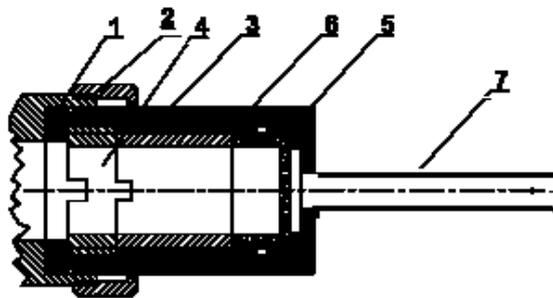
Рис. 3.б. Огнепреградитель для соединения с фторопластовой трубкой
