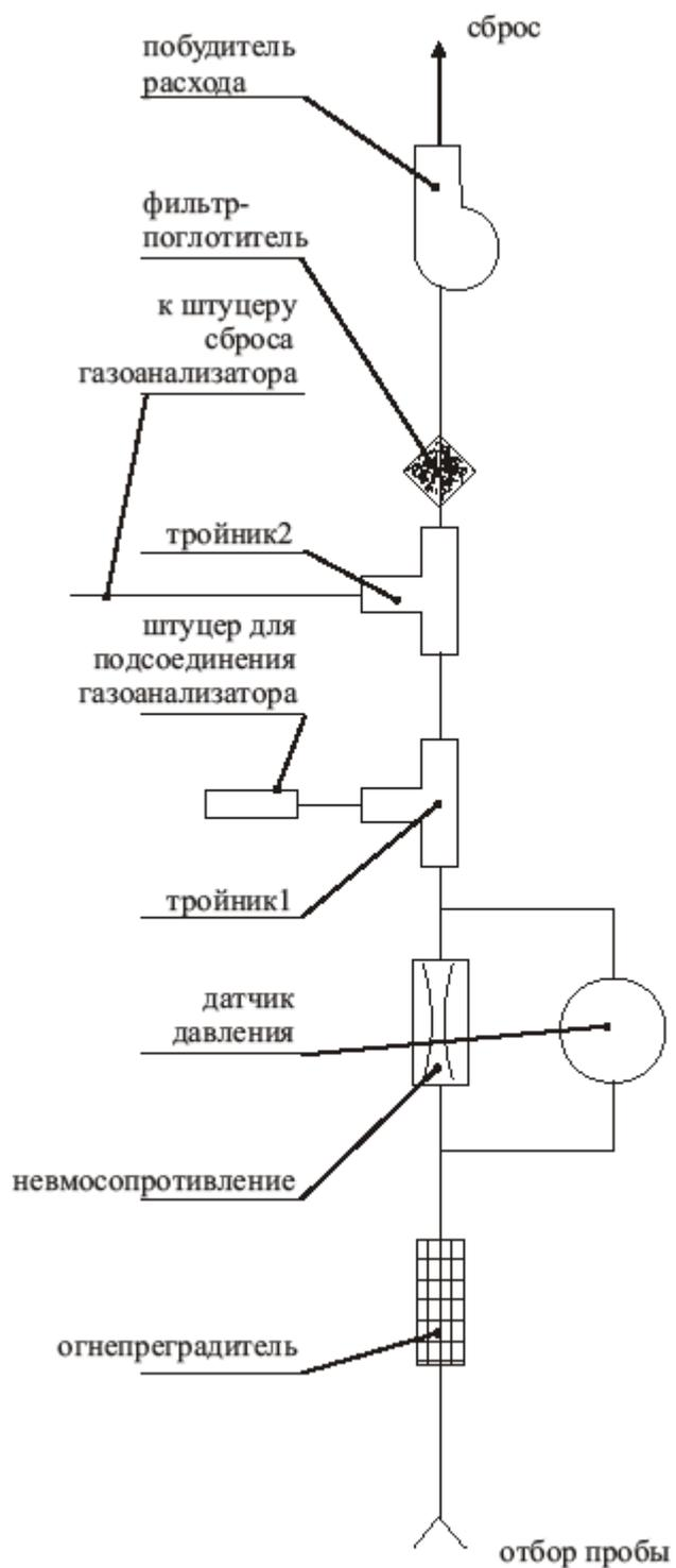
Рис. 2. Газовая схема
