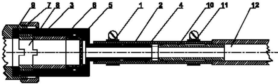
Рис. 3.а. Огнепреградитель для соединения с металлической трубкой
