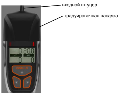
Рис. 3. Газоанализатор с градуировочной насадкой
