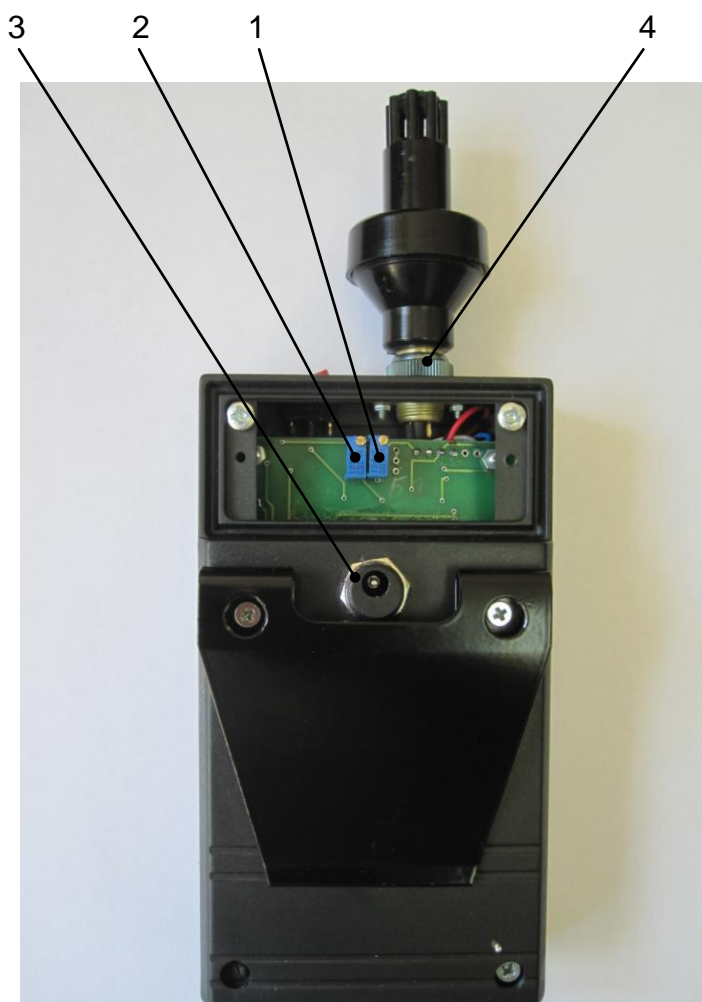
Рис.3. Вид газоанализатора СИГНАЛ-4 сзади со снятой крышкой.
