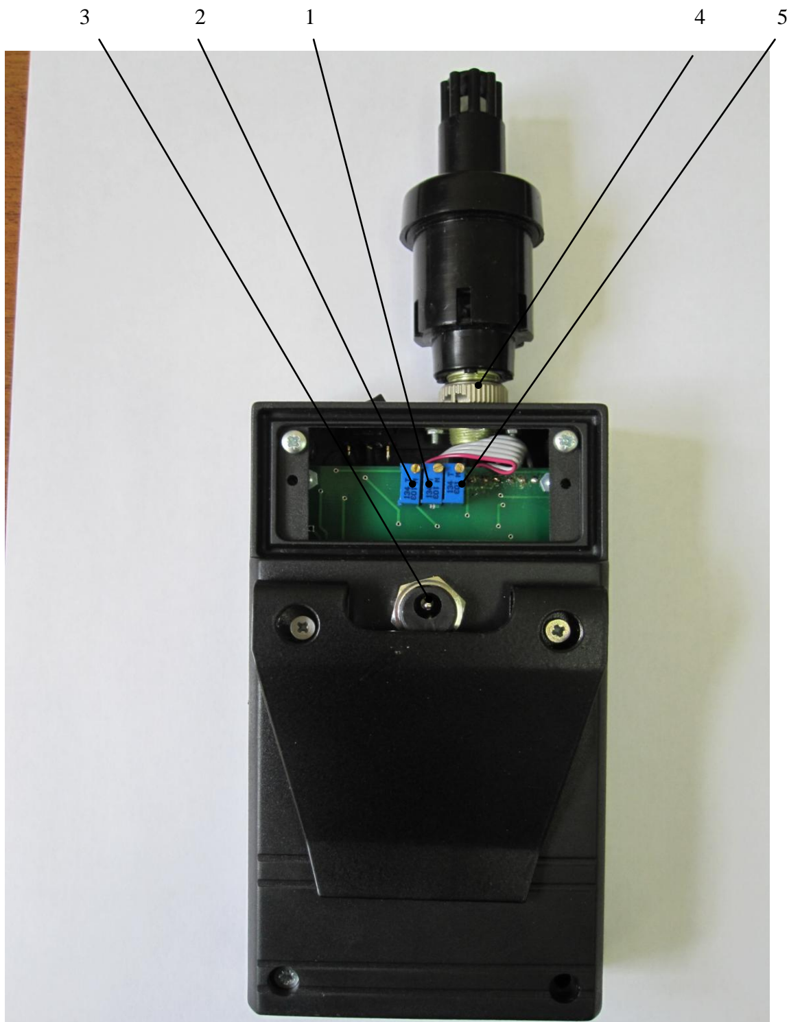
Рис.2. Вид газоанализатора СИГНАЛ -4КМ сзади со снятой крышкой.
