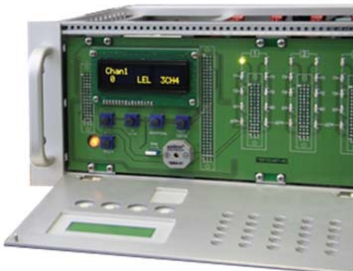
Рис.4. Дежурный режим работы УПЭС-50А и газоанализатора
