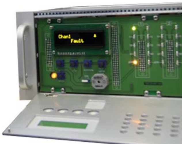
Рис. 4.3. Индикация «Требуется калибровка». Сопровождается звуковой сигнализацией
