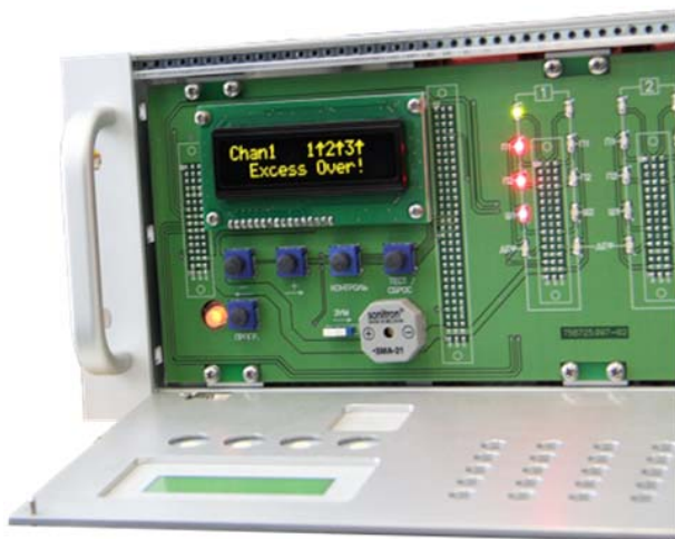
Рис. 4.5 Индикация «Превышение». Сопровождается звуковой сигнализацией
