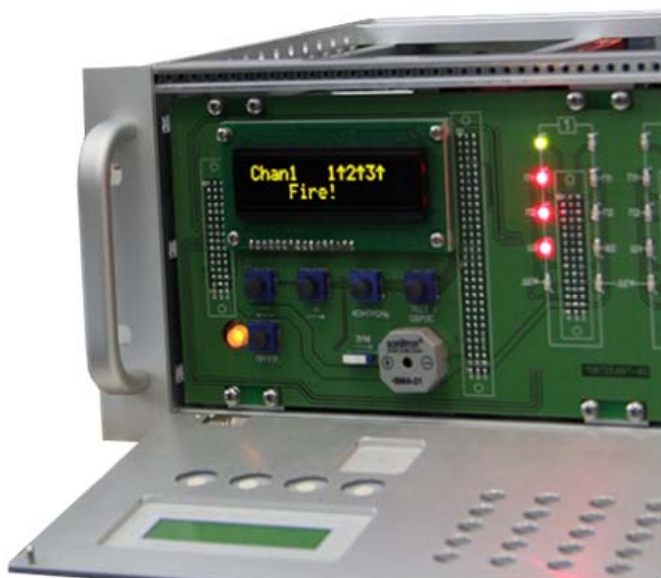
Рис. 3.1. Индикация пожара, сопровождаемая звуковой сигнализацией.
