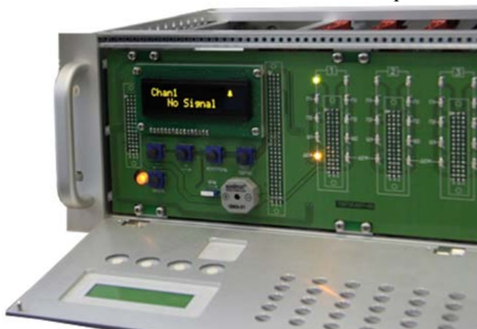
Рис.4.1. Индикация «Нет Сигнала». Сопровождается звуковой сигнализацией
