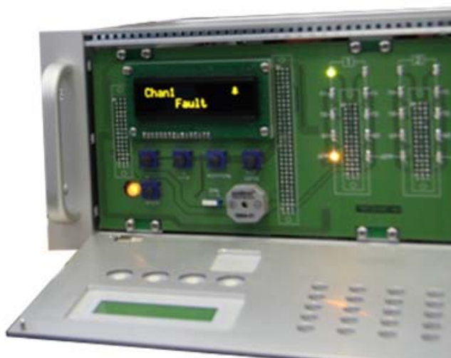
Рис. 3.4. Индикация УПЭС при потере связи с ИПЭС. Сопровождается звуковым сигналом.
