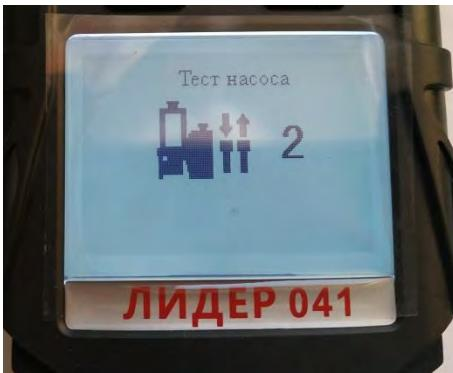
17. После появления на мониторе надписи «ЗАКР. ВХОД НАСОСА» закройте пальцем верхний входной штуцер насоса. Удерживайте палец до завершения обратного отсчета и появления надписи «Подача газа в норме».
