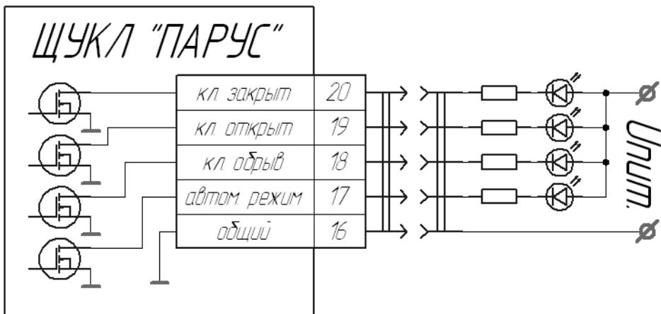
Рис. 4. Типовая схема подключения ИУ
