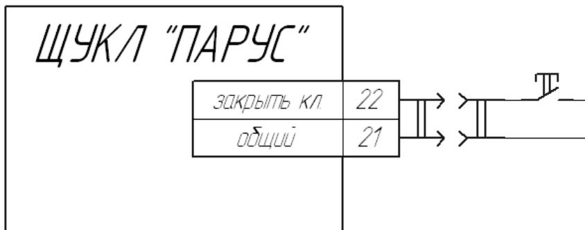
Рис. 5. Дискретный сигнал закрытия клапан
