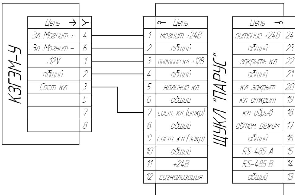
Рис. 3. Схема подключения клапана КЗГЭМ-У Приложение 4РЭ
