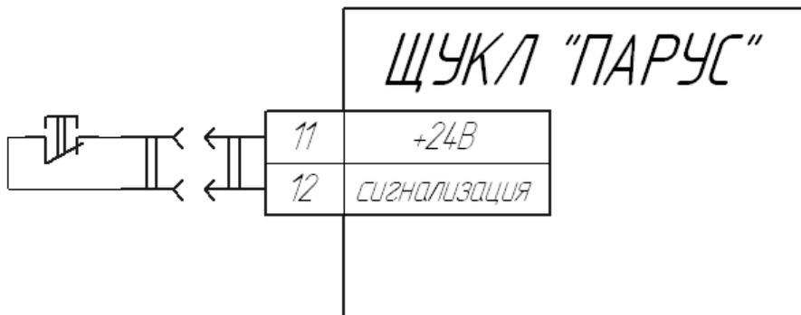
Рис. 6. Нормально-замкнутые выводы сигнализации.
