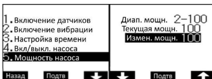
Рис. 10. Настройка мощности прокачки насоса
