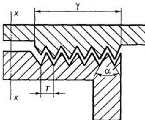
$x$  -  $x$  - ось сопрягаемых деталей;  $\alpha$  - угол зуба;  $T$  - ширина зуба;  $\gamma$  - длина зубчатой взрывозащитной поверхности
