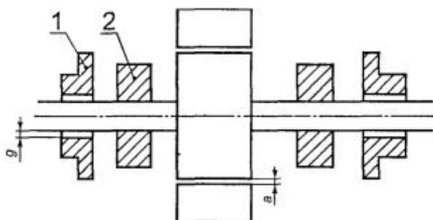
$a$  - радиальный зазор между статором и ротором;  $g$  - допустимое изменение радиального зазора в подшипниковом щите; 1 - подшипниковый щит; 2 - подшипник скольжения
