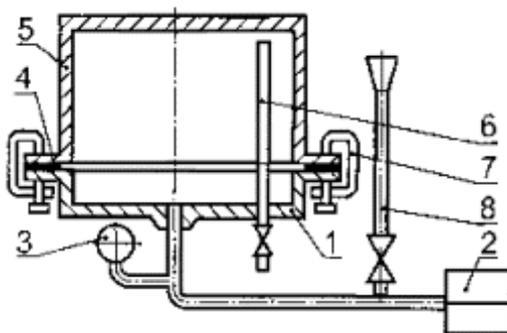
1 - стенд для гидравлических испытаний; 2 - устройство для создания давления воды (насос); 3- прибор для измерения давления; 4 - резиновая прокладка; 5 - испытываемая деталь; 6 - трубка для выхода воздуха при заполнении водой; 7 - струбцина для крепления испытываемой детали к стенду; 8 - трубка для предварительного заполнения оболочки водой
