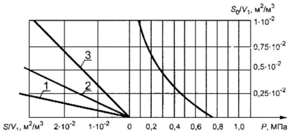
1 - для устройств с металлическими огнепреградителями; 2 - для устройств с огнепреградителями с гранулированной набивкой и сеточными огнепреградителями; 3 - для устройств с щелевыми огнепреградителями;  $V_1$  - свободный объем оболочки, м<sup>3</sup>;  $S$  - суммарная площадь сечения каналов огнепреградителя, м<sup>2</sup>,  $S_0$  - суммарная площадь сечения каналов, приведенная к эквивалентному отверстию, м<sup>2</sup>
