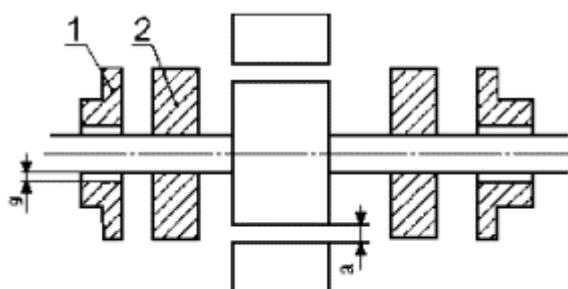
$a$  - радиальный зазор между ротором и статором;  $g$  - радиальное перемещение, допускаемое подшипниковым щитом; 1 - подшипниковый щит; 2 - подшипник скольжения
