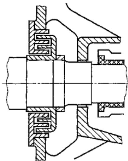
Примечание - Лабиринтное взрывонепроницаемое соединение с параметрами, отличающимися от приведенных в [таблицах 1-4](#) (см. [5.1](#))
