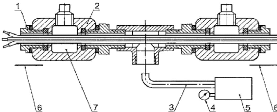
1 - уплотнения (удаляемые во время испытаний); 2 - узел герметичного вводного устройства; 3 - гибкий шланг; 4 - манометр; 5 - гидравлический насос; 6 - бумага; 7 - эпоксидный компаунд
