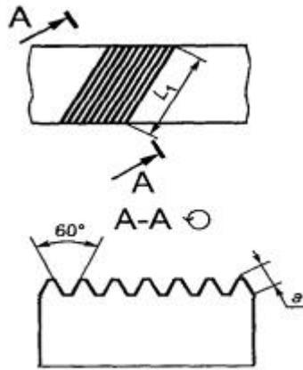
Рисунок Б.1 - Пример взрывозащитной поверхности щелевого огнепреградителя разгрузочного устройства с канавками сечением в виде равностороннего треугольника
