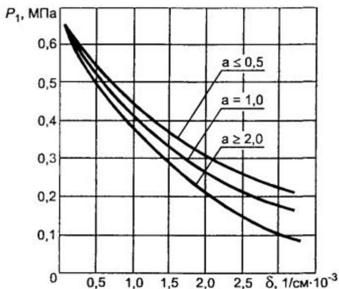
$A = V_1/V_2$  - кратность объемов отделения, в котором происходит разгрузка давления (объем  $V_1$ ) и смежного отделения (объем  $V_2$ )
