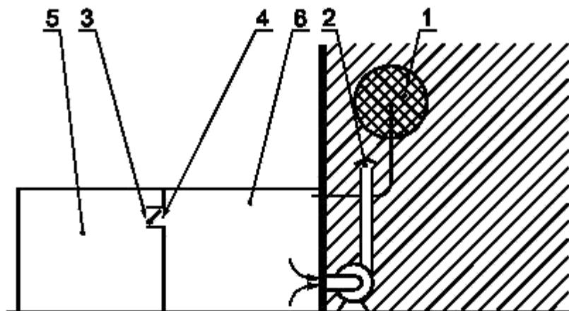
1 — вытяжная труба отбора проб; 2 — выход воздуха из помещения; 3 — запорное устройство;
