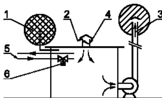
1 — вытяжная труба отбора проб; 2 — вход воздуха для вентиляции; 3 — выход воздуха из помещения;
