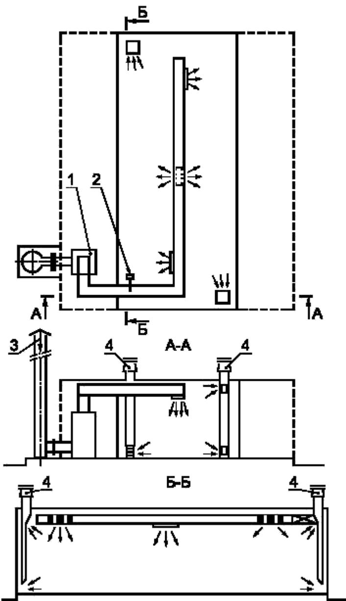
1 — вентиляционное оборудование; 2 — датчик расхода; 3 — вход воздуха; 4 — выходы воздуха
