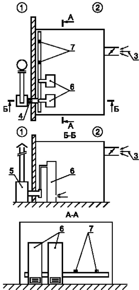
1 — взрывоопасная зона; 2 — взрывобезопасная зона; 3 — вход воздуха; 4 — датчик расхода; 5 — вентиляционное оборудование; 6 — кожухи анализаторов, соединенные с вентиляционными коробами; 7 — запасные соединения для дополнительных анализаторов
