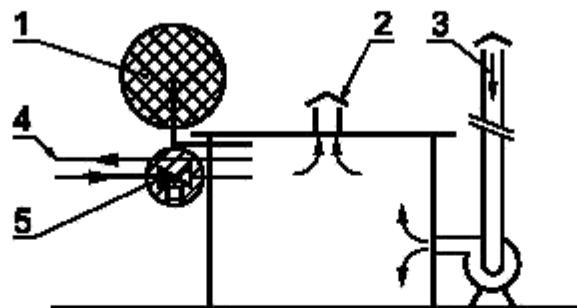
1 — вытяжная труба отбора проб; 2 — выход воздуха из помещения; 3 — вход воздуха для вентиляции;
