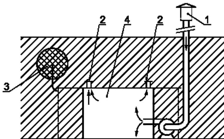
1 — вход воздуха для вентиляции; 2 — выходы воздуха из помещения; 3 — вытяжная труба отбора проб;
