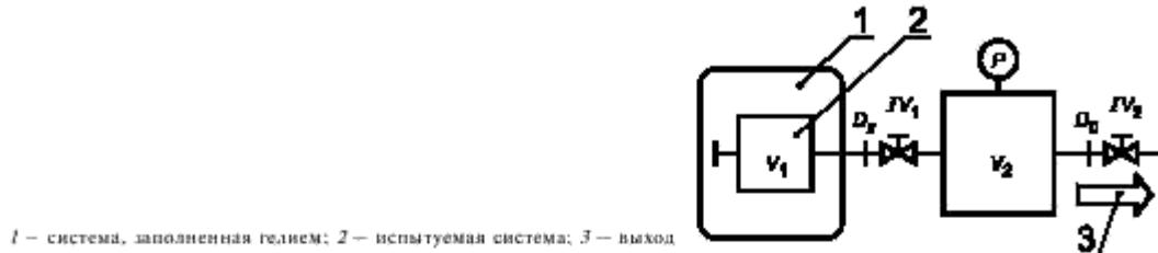
Рисунок Ж.1 — Схема испытания неповреждаемости
