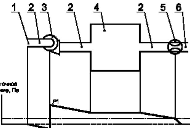
1 — вход защитного газа; 2 — газопровод; 3 — вентилятор; 4 — оболочка; 5 — дроссельная заслонка; 6 — выход защитного газа;  $P_1$  — давление защитного газа. Определяется по сопротивлению потоку через газопровод, через части внутри оболочки и в ряде случаев — через дроссель.
