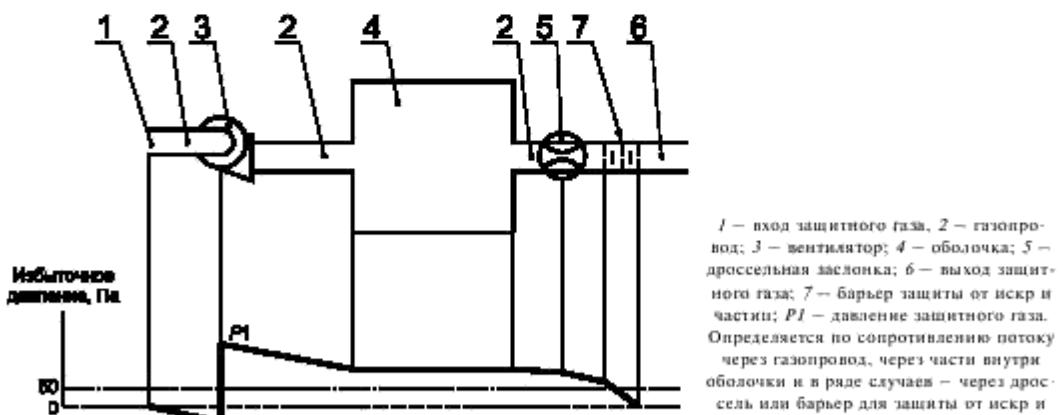
1 — вход защитного газа, 2 — газопровод; 3 — вентилятор; 4 — оболочка; 5 — дроссельная заслонка; 6 — выход защитного газа; 7 — барьер защиты от искр и частиц;  $P_1$  — давление защитного газа. Определяется по сопротивлению потоку через газопровод, через части внутри оболочки и в ряде случаев — через дроссель или барьер для защиты от искр и
