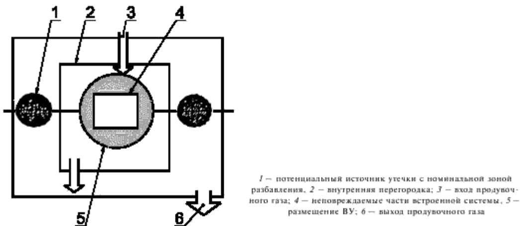
Рисунок Е.2 — Пример использования неповреждаемой встроенной системы
