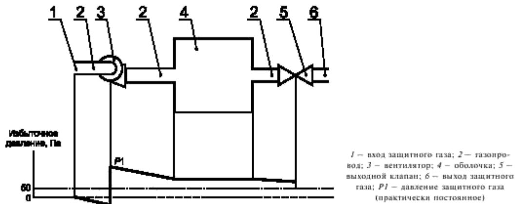
Примечание — Вход защитного газа расположен в безопасной зоне.
