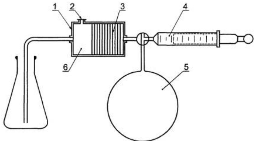
1 - огнепрепрятитель; 2 - предохранительная мембрана; 3 - пластиинки из спеченного стекла (перегородки); 4 - герметичный шприц;
