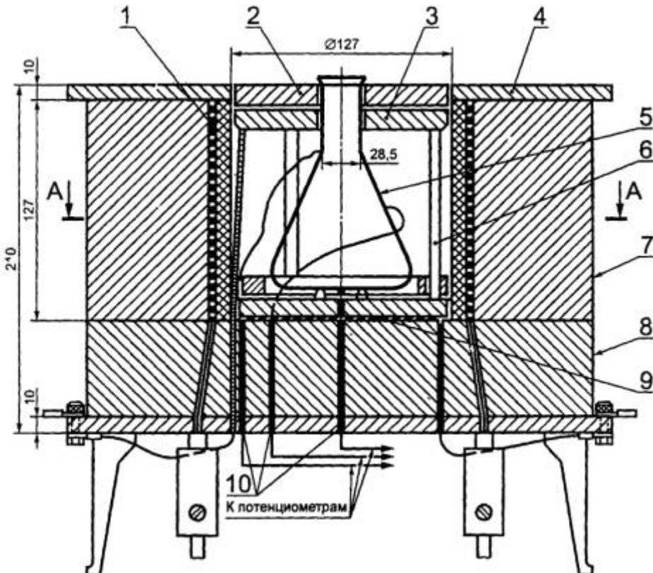
1 - основной нагреватель; 2 - кольцо крышки; 3 - обогреватель горловины; 4 - крышка из огнеупорного материала; 5 - колба вместимостью 200 см<sup>3</sup>; 6 - керамическая опора; 7 - поддерживающий цилиндр; 8 - электрический тигель печи; 9 - основной нагреватель; 10 - термопары
