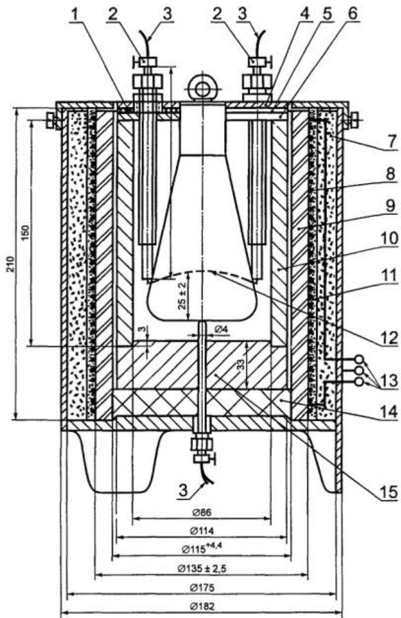
1 - высокотемпературная изоляция; 2 - зажимные втулки; 3 - термопары; 4 - верхняя часть крышки; 5 - изоляционное кольцо; 6 - нижняя часть крышки; 7 - теплоизоляция; 8 - нагреватель, 9 - керамическая трубка; 10 - стальной цилиндр; 11 -
