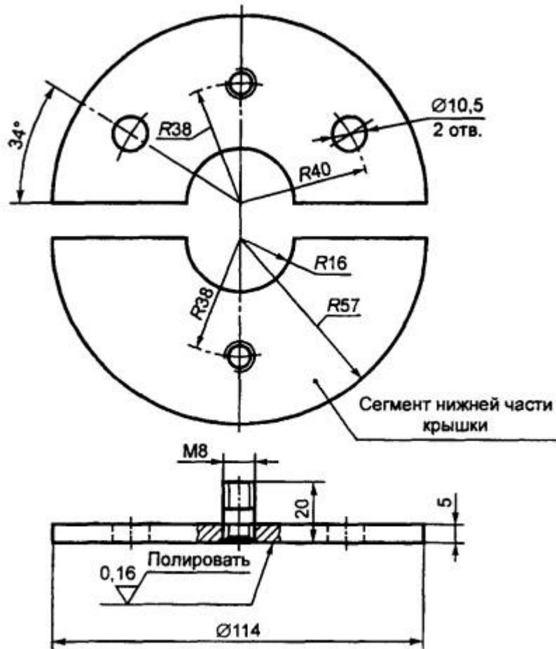
Рисунок А.9 - Крышка стального цилиндра
