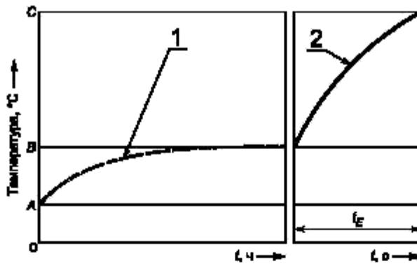
$A$  — наимышая допустимая окружающая температура;  $B$  — температура вnominalном режиме работы;  $C$  — предельная температура;  $t$  — время; 1 — повышение температуры вnominalном режиме работы; 2 — повышение температуры статора и ротора при испытании электродвигателя с заторможенным ротором
