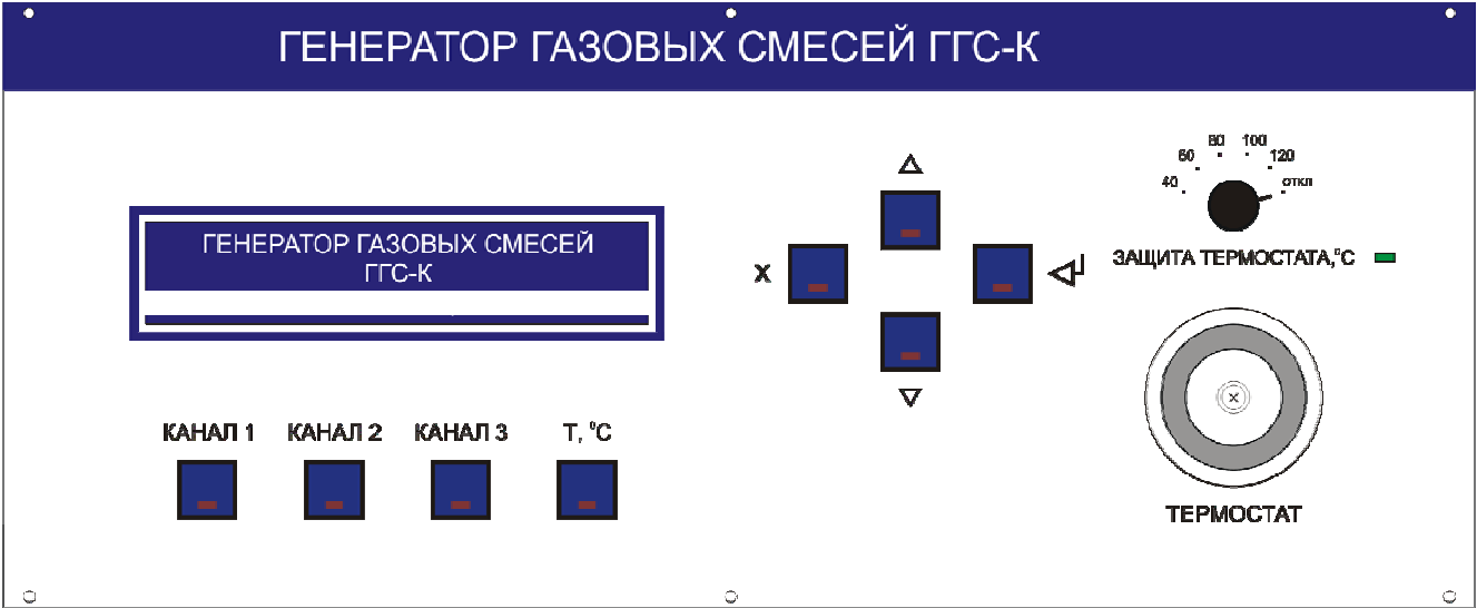
Рис 6. Вид лицевой панели рабочего эталона ГГС-К
