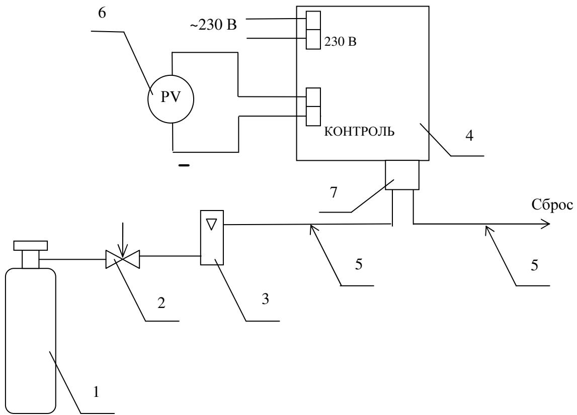
1 – баллон с ГСО-ПГС; 2 – вентиль точной регулировки; 3 – индикатор расхода;
