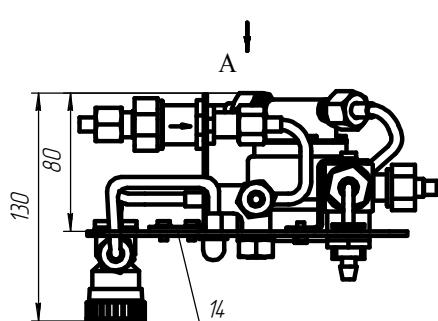
Рисунок В.3 - Датчик под пайку кабеля
