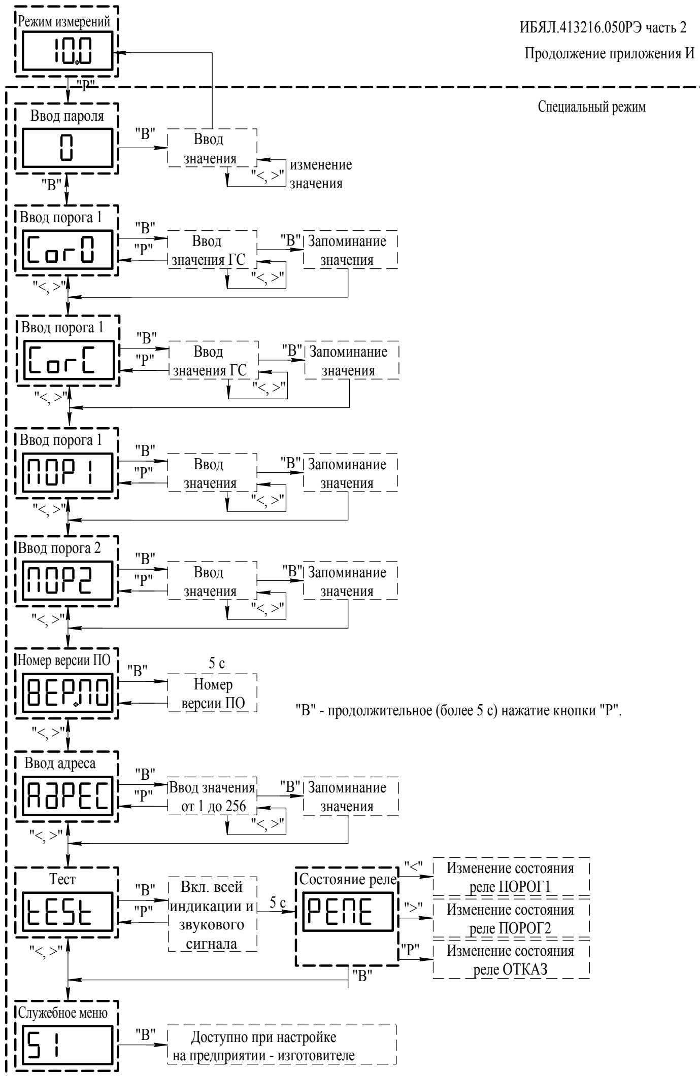
Рисунок И.1 - Алгоритм режимов работы БСП сигнализаторов с цифровой индикацией
