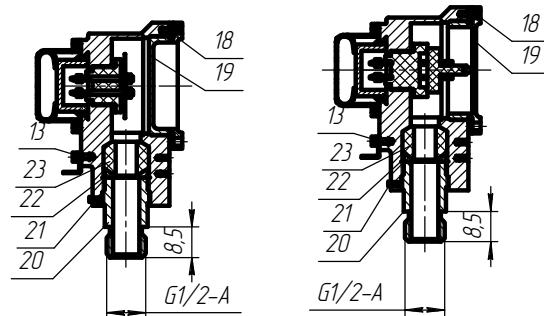
Рисунок В.4 - Датчик с разъемным соединением
