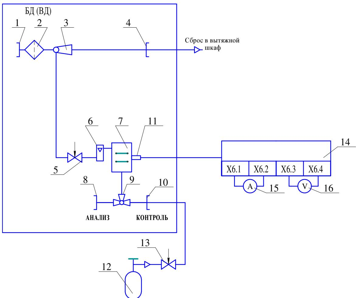
Газовые соединения выполнить трубкой ПВХ 4x1,5
