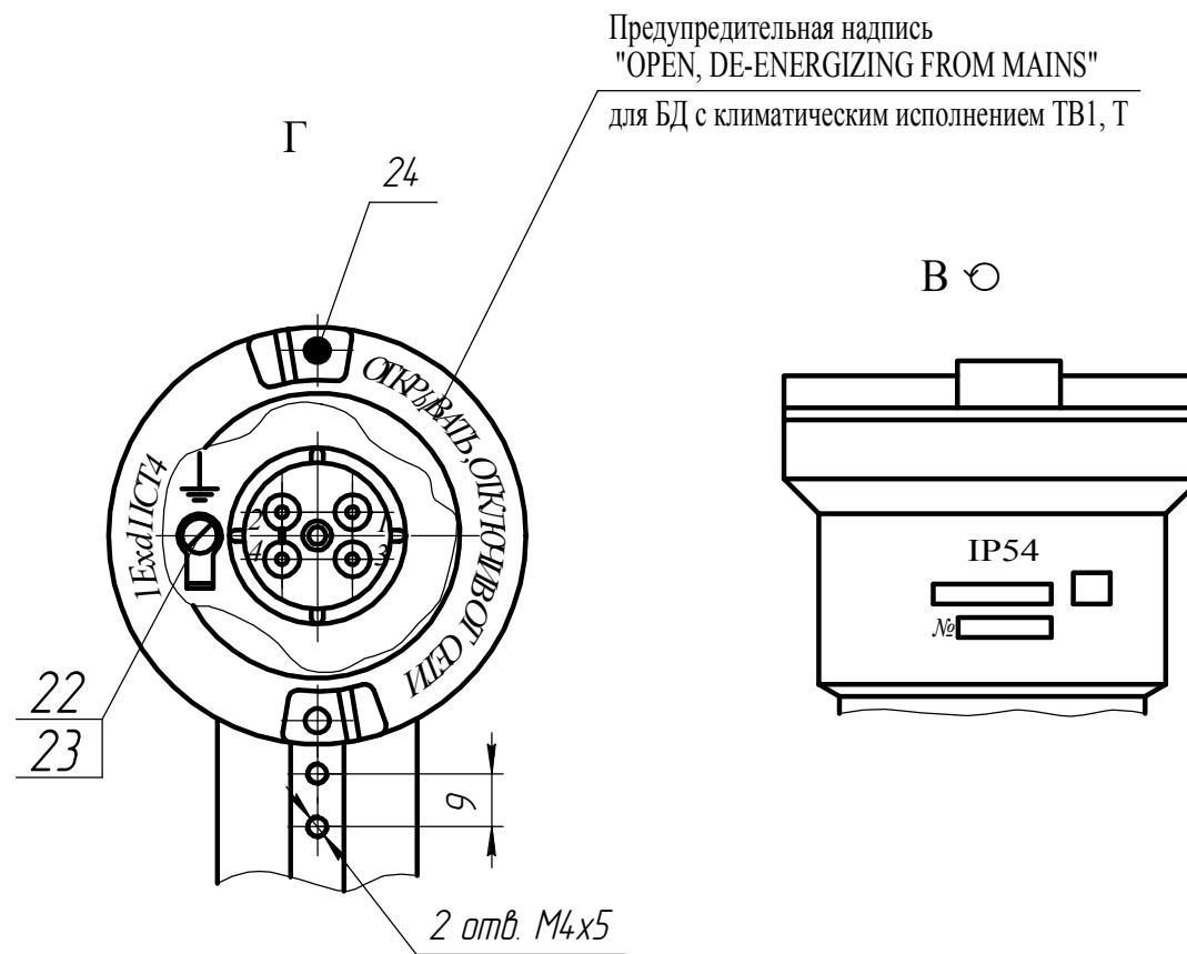
Рисунок Г.2 - Датчик с разъемным соединением
