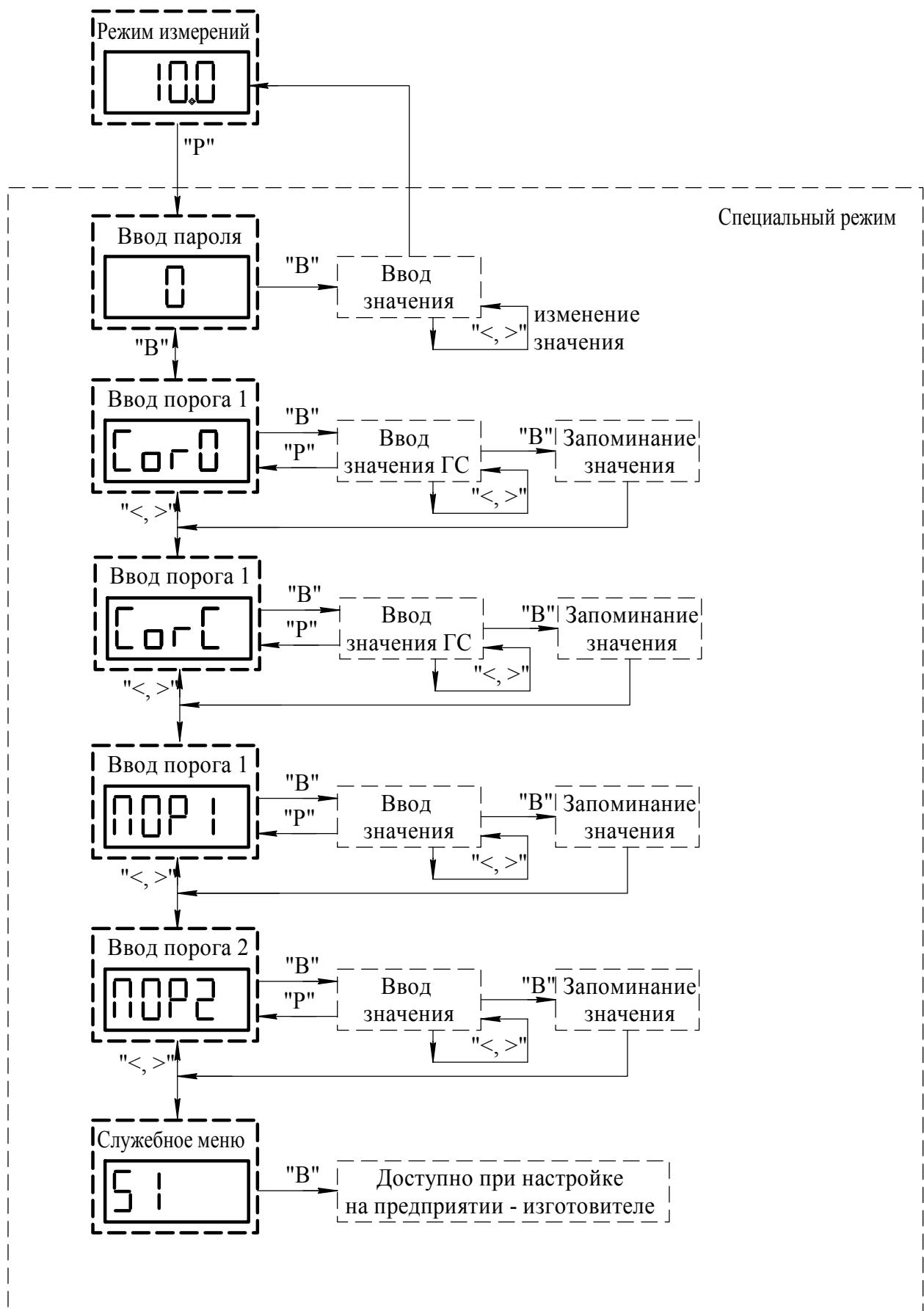
Рисунок Е.3 - Алгоритм режимов работы БД сигнализаторов
