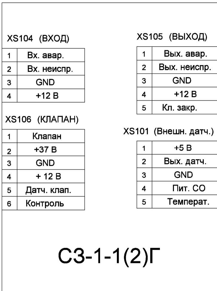
Рисунок Б - Схема внешних соединений сигнализатора
