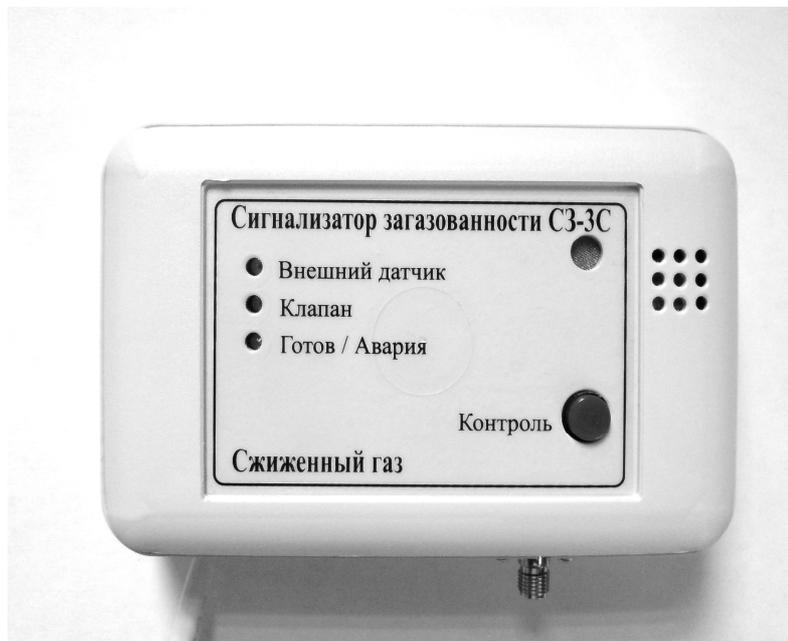
Рисунок 1 – Внешний вид сигнализатора СЗ-3С
