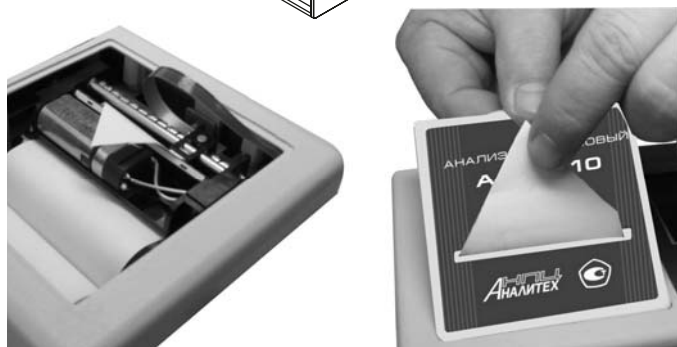
Рис Б.2. Газоанализатор АГМ-510, замена бумаги в принтере.
