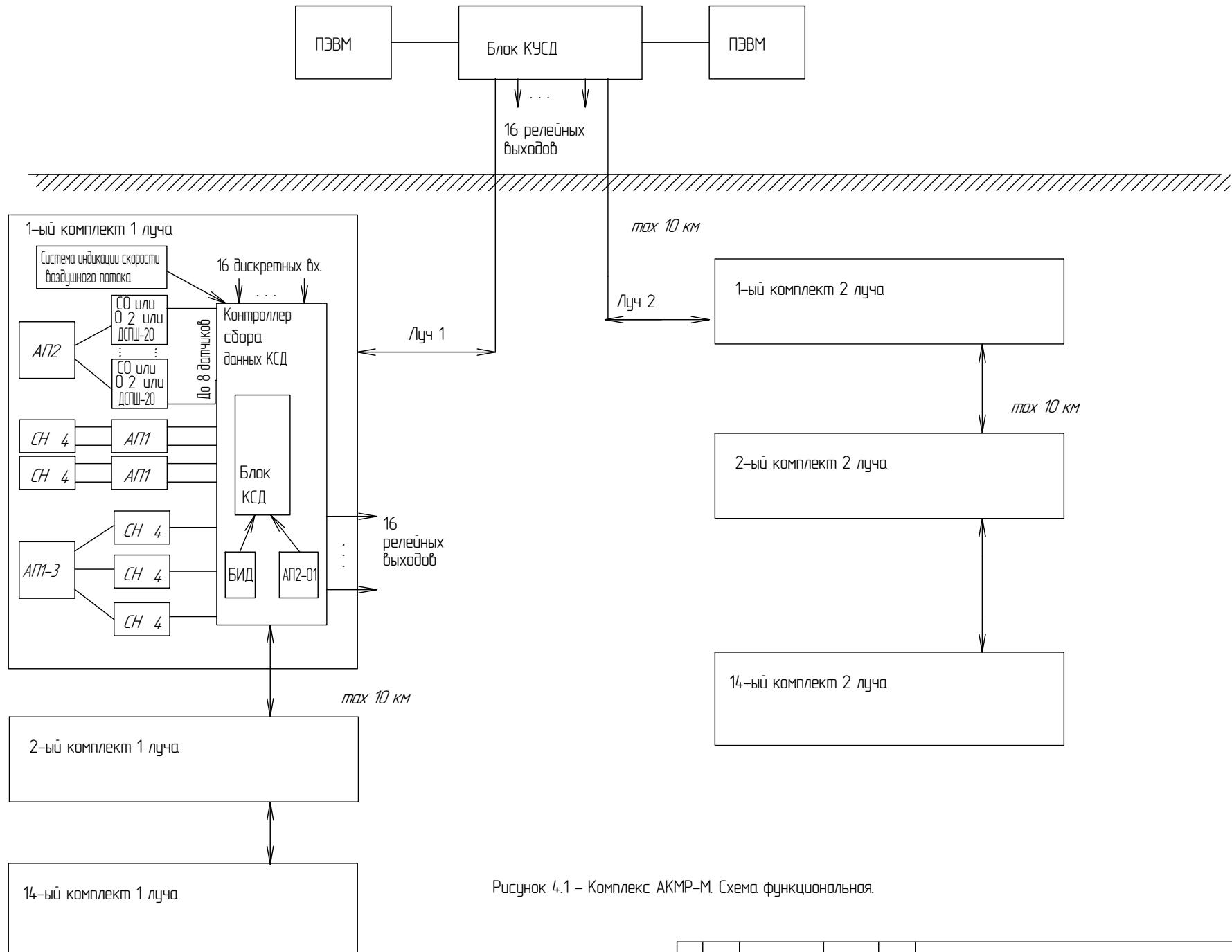
Рисунок 4.1 – Комплекс АКМР-М. Схема функциональная.
