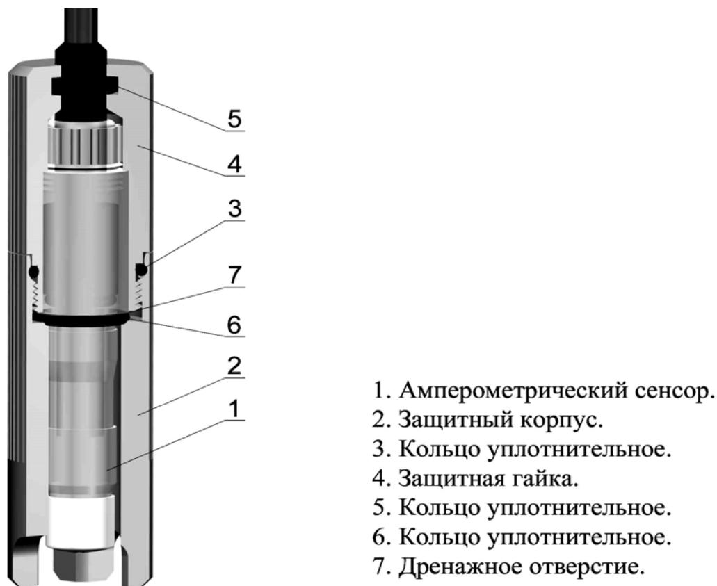
Рис. 4.3. Внешний вид АСрО<sub>2</sub>-05 погружного типа.
