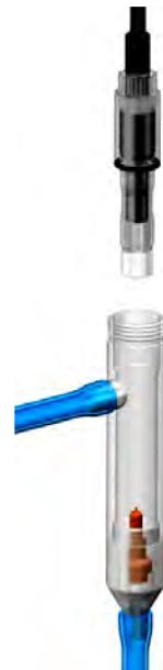
Рис. 3.9. Установка АСрО<sub>2</sub> в измерительную камеру
