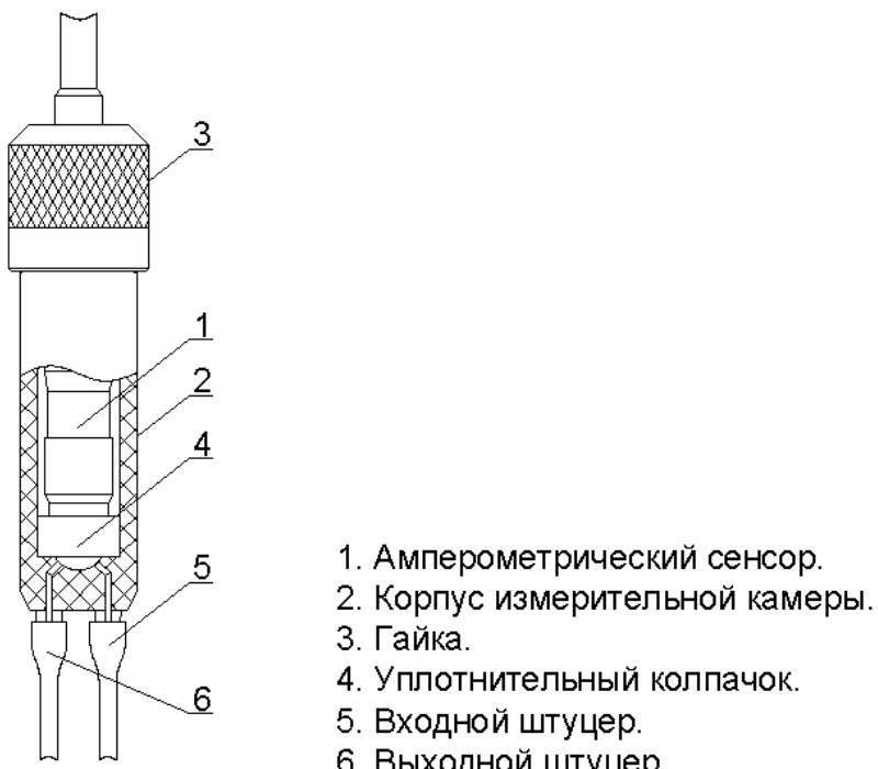
Рис.4.4. Измерительная камера для микроанализа.
