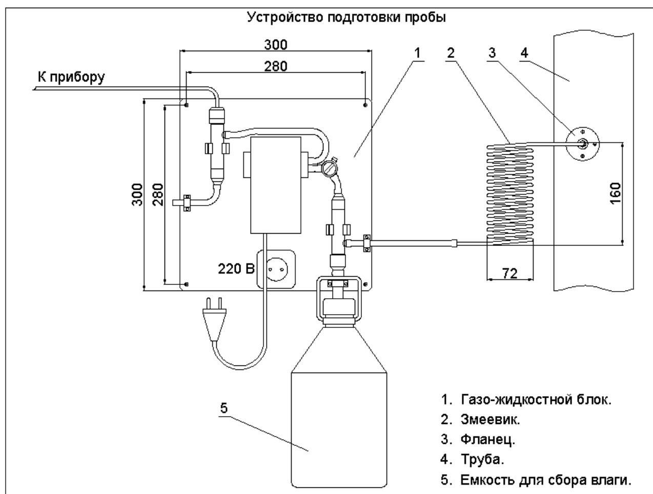
Рис. 10.3 Принципиальная схема УПГП-01.
