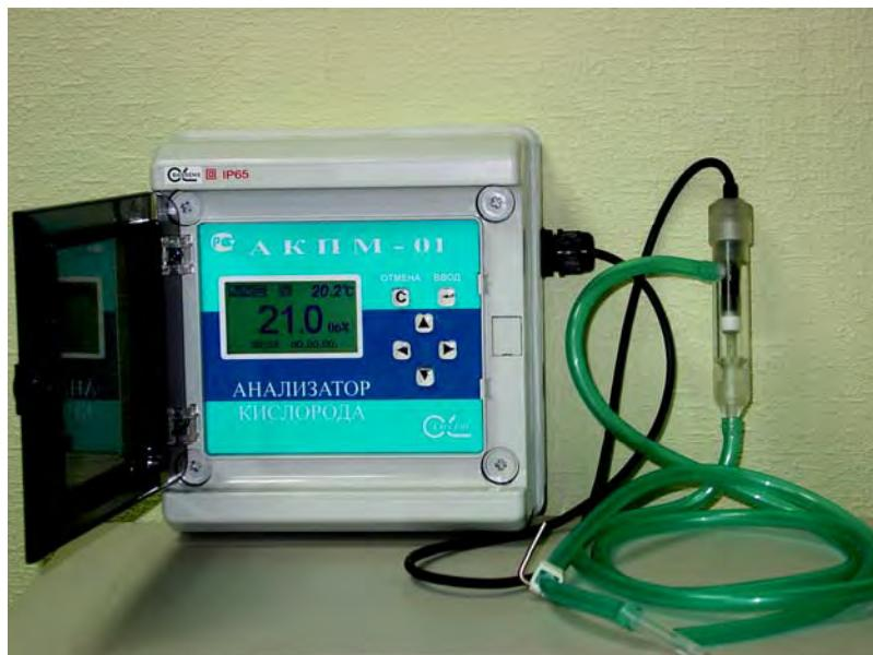
Рис. 2.3. Внешний вид анализатора АКПМ-1-01Т
