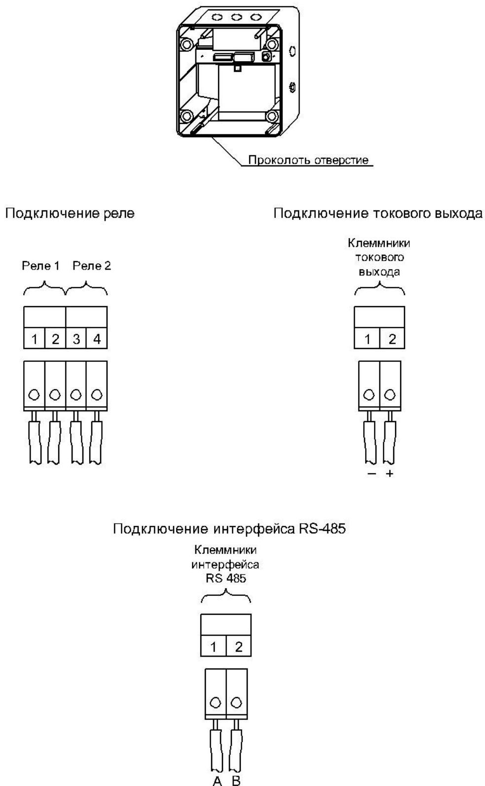
Рис.7.2. Подключение токового выхода, RS-канала и реле.
