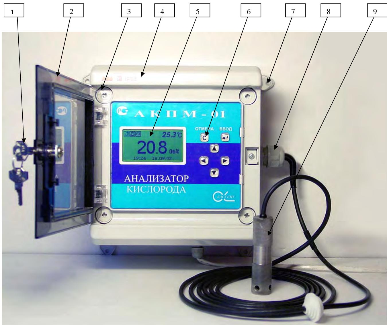
Рис. 4.1. Внешний вид анализатора кислорода АКПМ-1-01.
