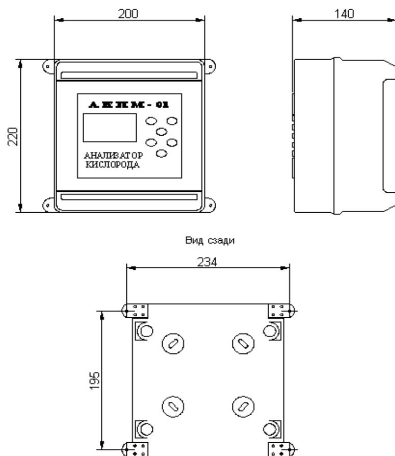
Рис.7.3. Установка анализатора.
