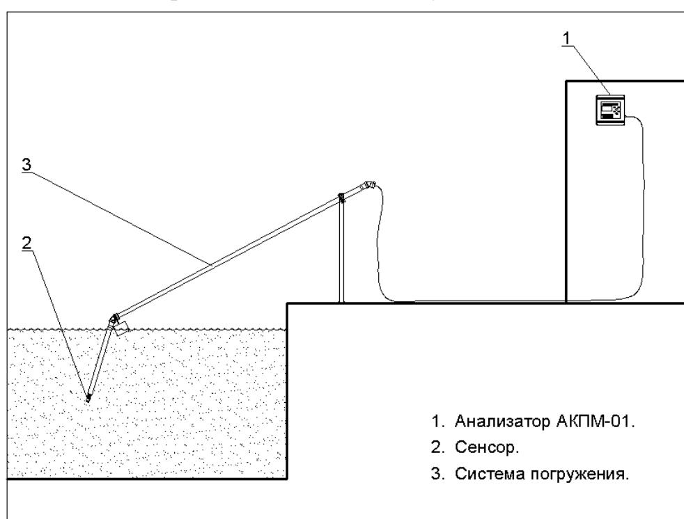
Рис. 10.5 Схема установки АСрО<sub>2</sub> в аэротенке с помощью системы погружения.
