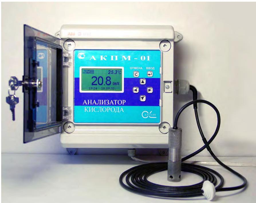
Рис. 2.4. Внешний вид анализатора АКПМ-1-01П
