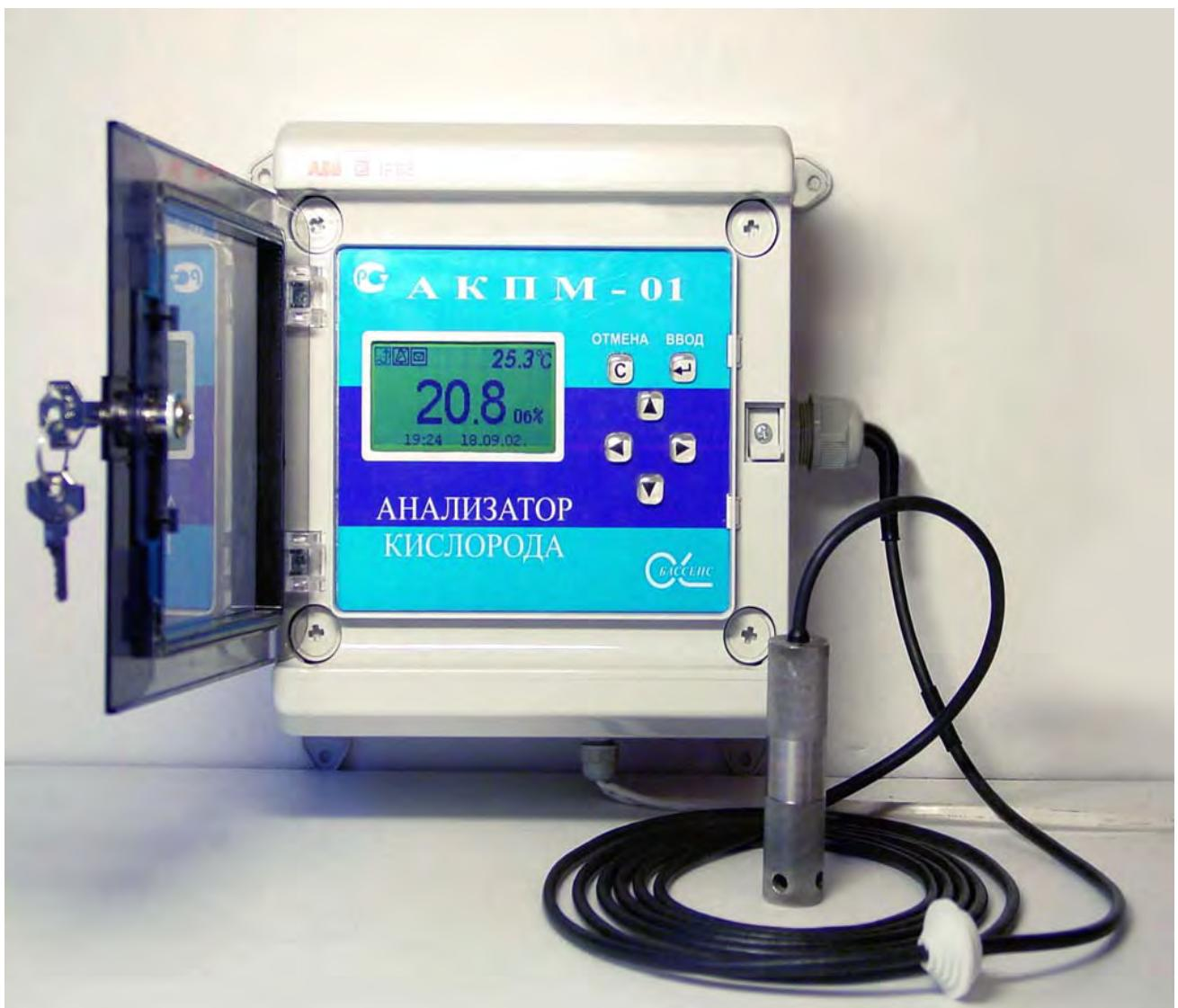
Рис. 1. Внешний вид анализатора кислорода АКПМ-1-01
