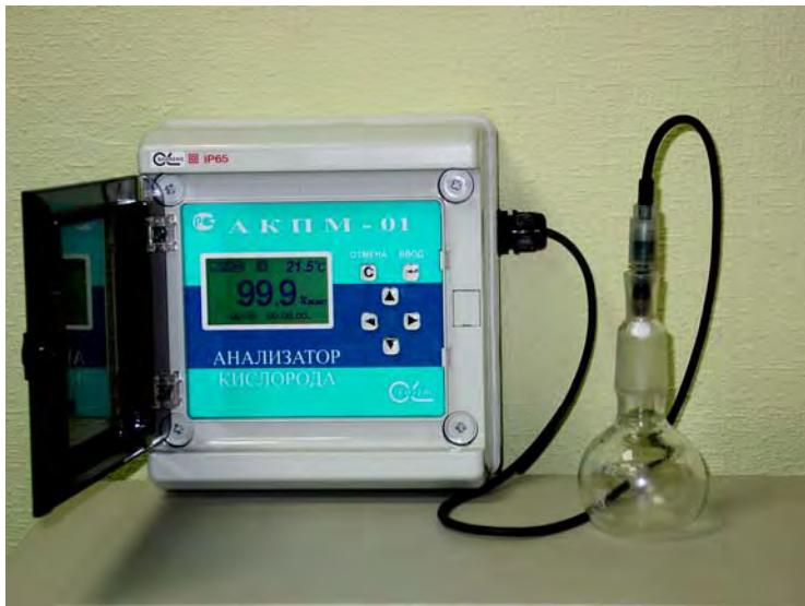
АКПМ-1-01Л в комплекте с АСрО<sub>2</sub>-01 предназначен для измерений концентрации и биохимического потребления кислорода (БПК) в стандартных склянках в лабораторных условиях. Применяется в экологических и химических лабораториях различных промышленных предприятий, ЦГСЭН, ЖКХ, организациях Госком-
