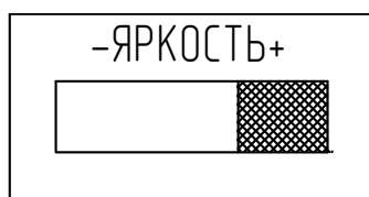
Рисунок 2.15 – Установка яркости индикатора
