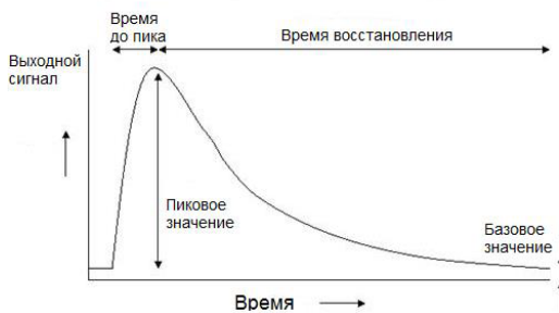
Рисунок 2. Форма изменения сигнала электрохимического датчика
