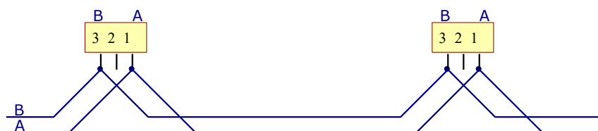
Рис. 6. Соединение газоанализаторов с кабелем витая пара без ответвлений
