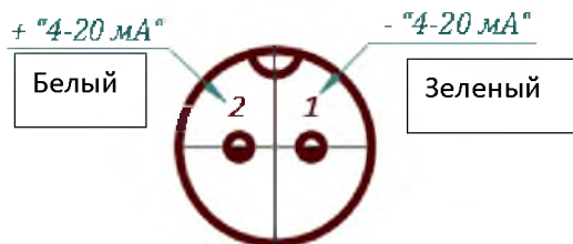
Рисунок 18 - Схема подключения блочной вилки (вид на корпус)
