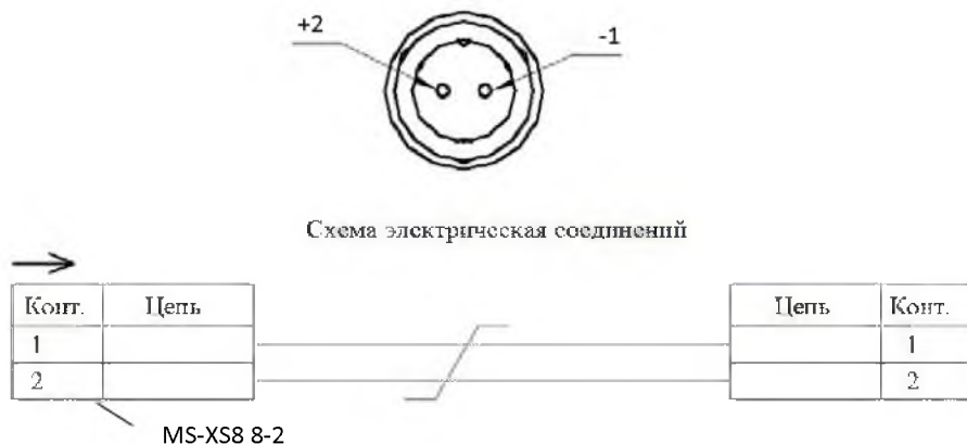
Рисунок 35 - Назначение контактов блочного разъема 4-20 мА (вид на прибор)
