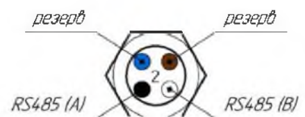
Рисунок 41 – Распиновка кабельных вводов
