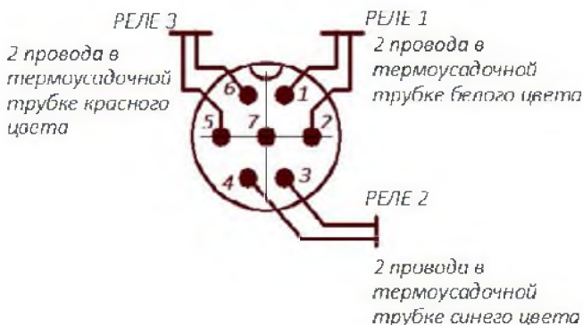
Рисунок 24 - Схема подключения блочной вилки разъема «сухие контакты»
