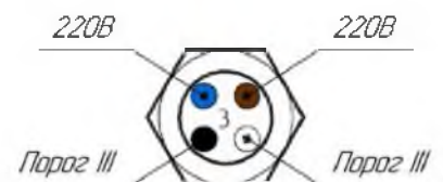
Рисунок 41 – Распиновка кабельных вводов
