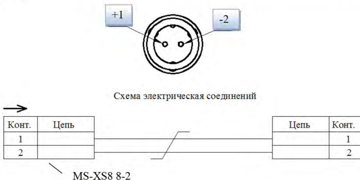
Рисунок 11 – Нумерация выводов в разъёме 4-20 мА
