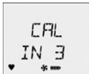
3. **AUTO-ZERO** будет мигать во время обнуления всех датчиков и калибровки датчика кислорода. Если датчик не сможет выполнить автоматическую настройку нуля, его диапазон не может быть установлен. Когда автоматическая установка нуля будет завершена, на дисплее появится **APPLY GAS** (подать газ).
