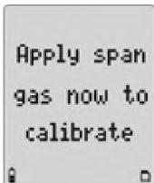
5. Выберите датчик для калибровки. Нажмите и для прокрутки на требуемый датчик и затем нажмите для выбора. Датчики должны калиброваться в следующем порядке:
