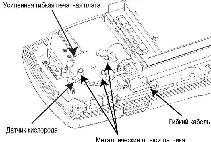
1. Аккуратно снимите круглую усиленную гибкую печатную плату, расположенную поверх датчика, с металлических штырей датчика. Соблюдайте осторожность, чтобы не повредить гибкий кабель.
