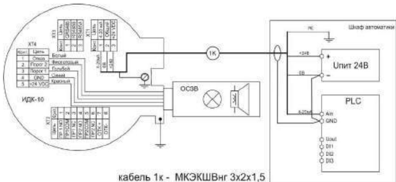
Рисунок Д.2 – Пример схемы внешних подключений ИДК-10 с ОСЗВ
