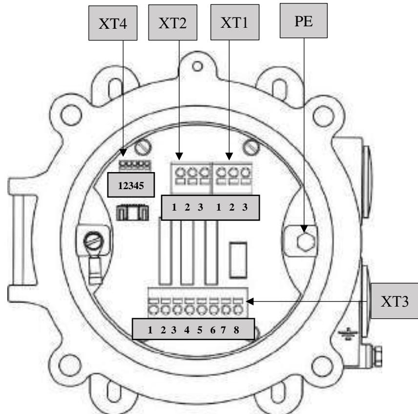
Рисунок 9 – Бокс подключения
