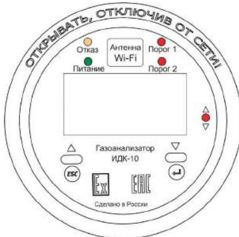
Рисунок 6 - Общий вид индикационной панели ИДК-10
