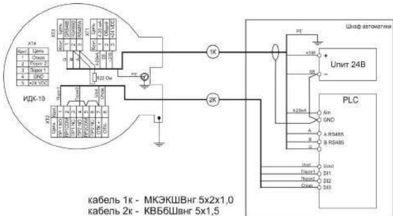
Рисунок Д.1 – Пример схемы внешних подключений ИДК-10
