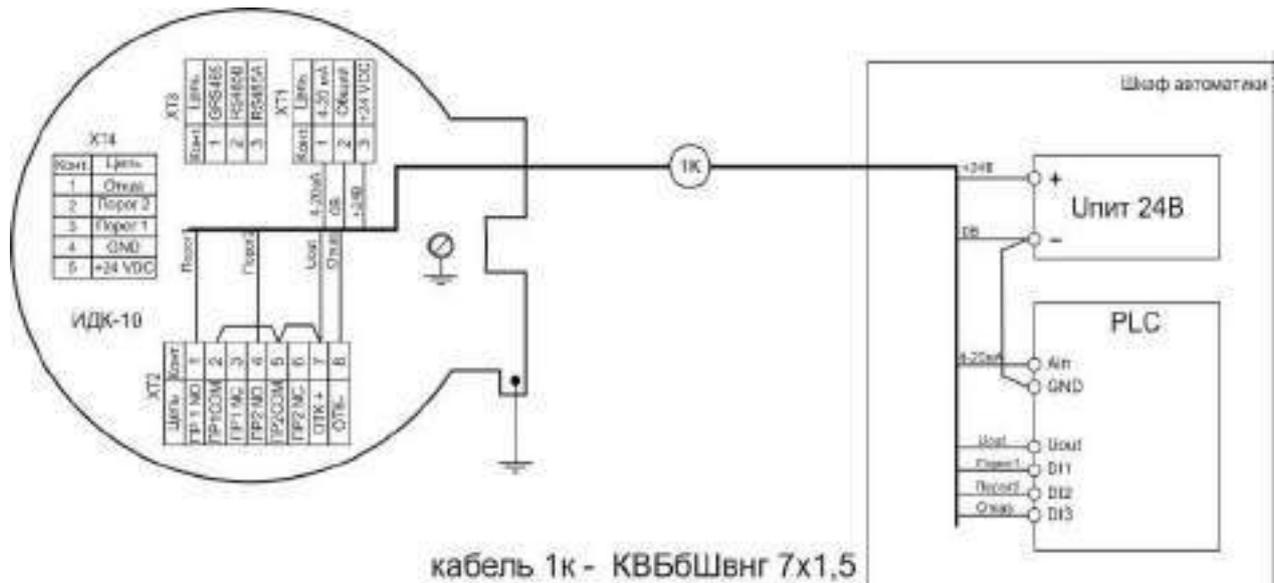
Рисунок Д.3 – Пример схемы внешних подключений ИДК-10 дним кабелем (только при коммутации дискретными выходами напряжение постоянного тока до 30 В)
