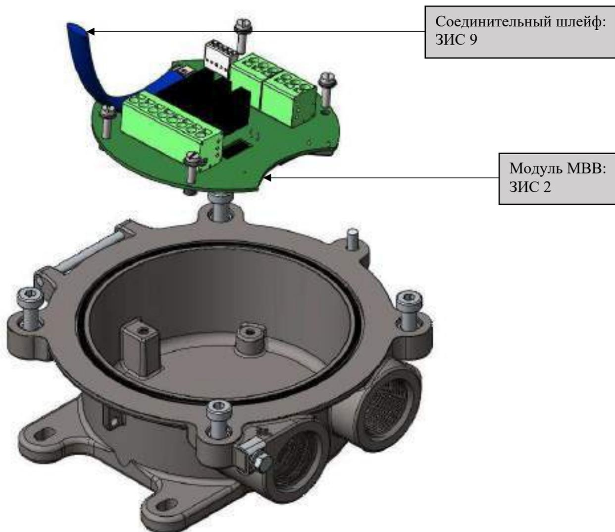
Рисунок И.3 – Бокс подключения, расположенный в основании корпуса
