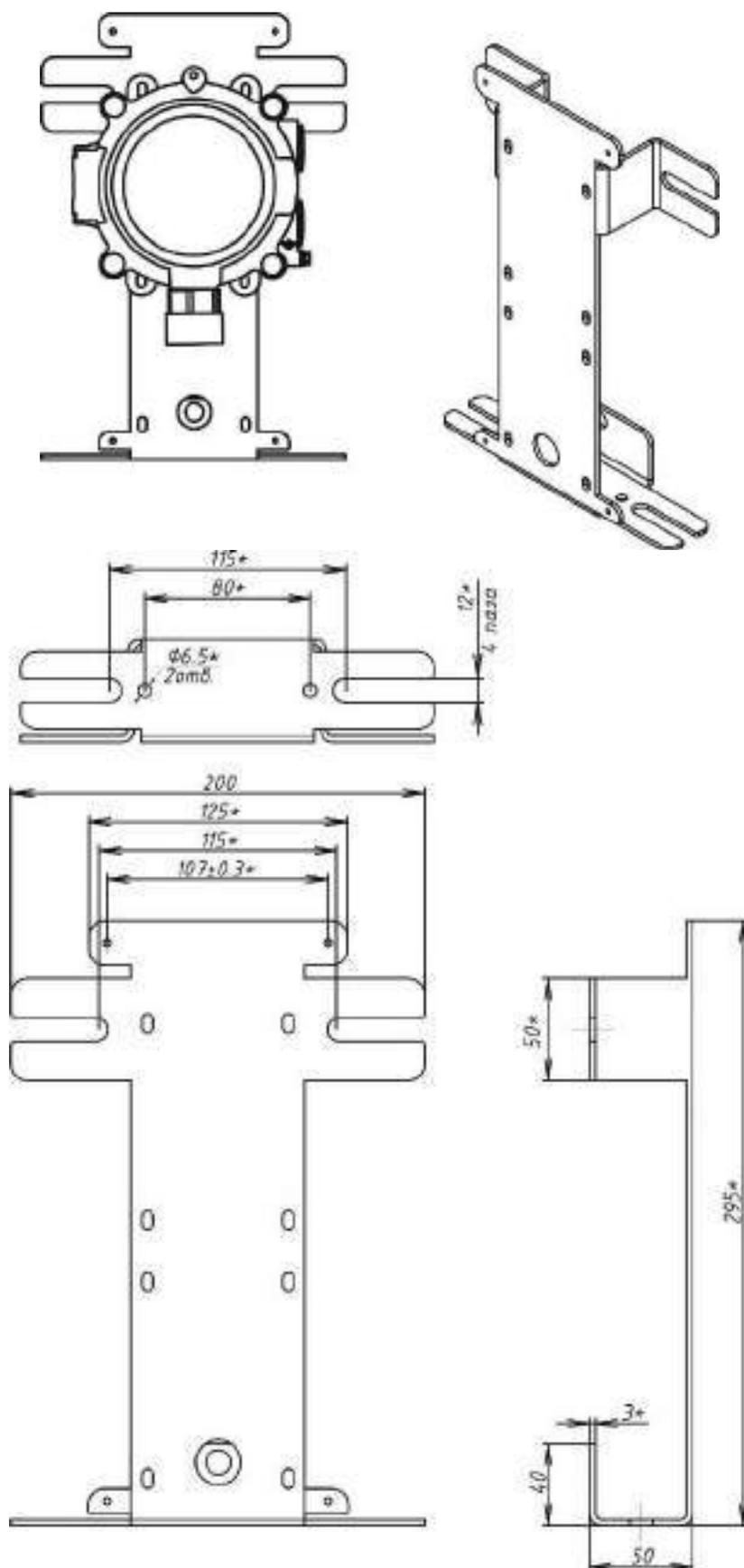
Рисунок Б.5 – Пластина монтажная ОФТ.18.2272.00.00.00 ЗИ68
