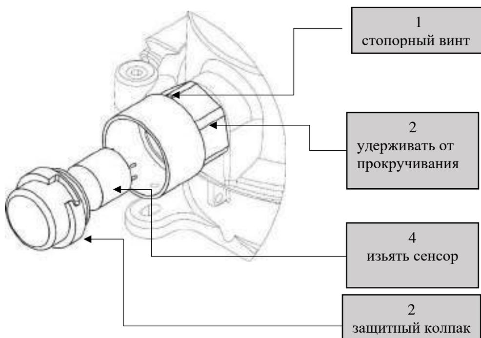
Рисунок 13 - Порядок замены оптического сенсора
