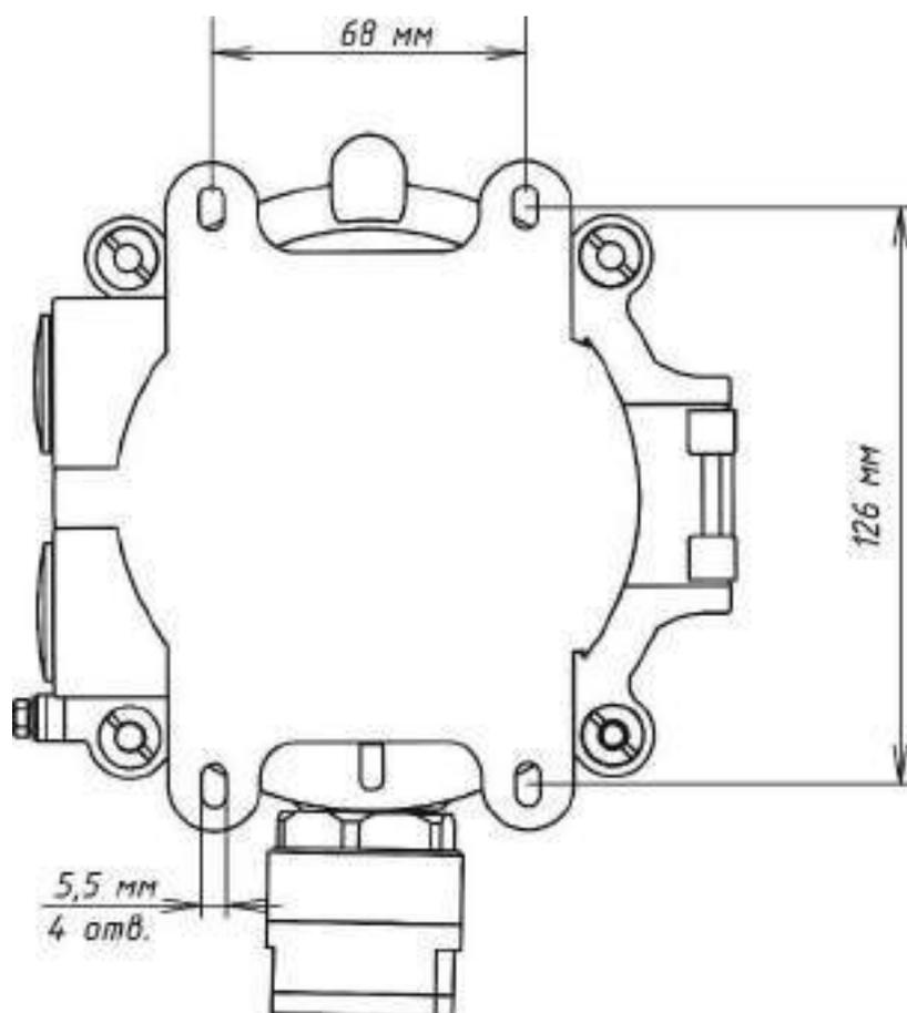
Рисунок Б.4 - Крепежные размеры ИДК-10
