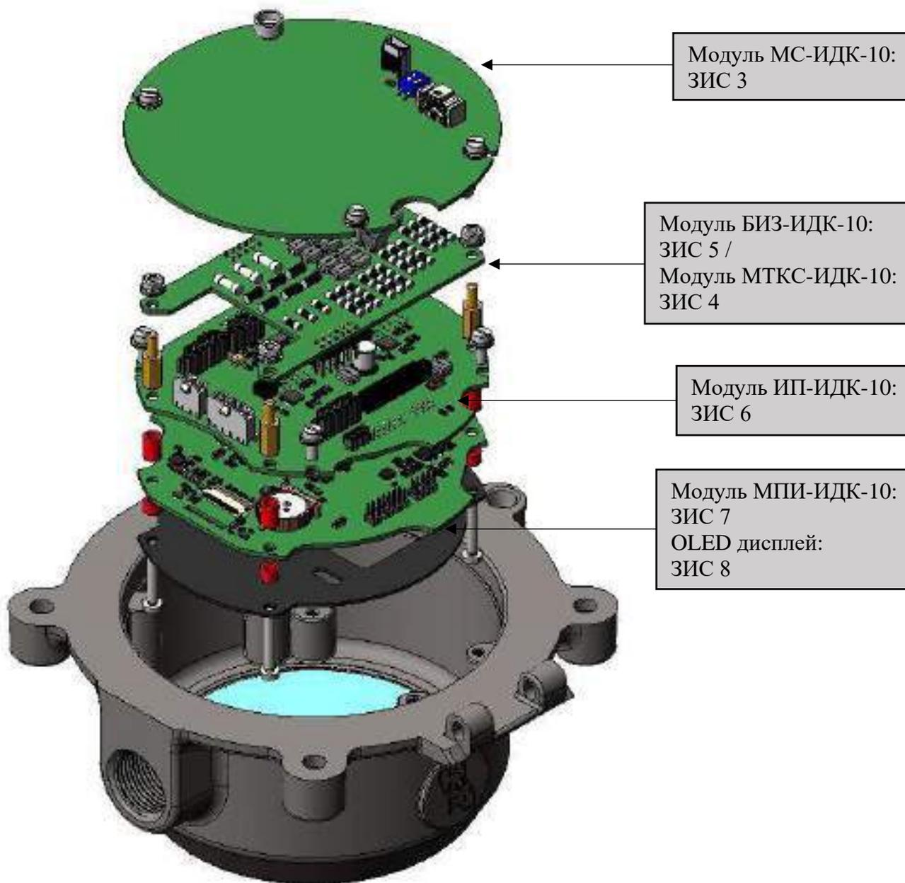
Рисунок И.3 – Блок электроники, расположенный в крышке корпуса
