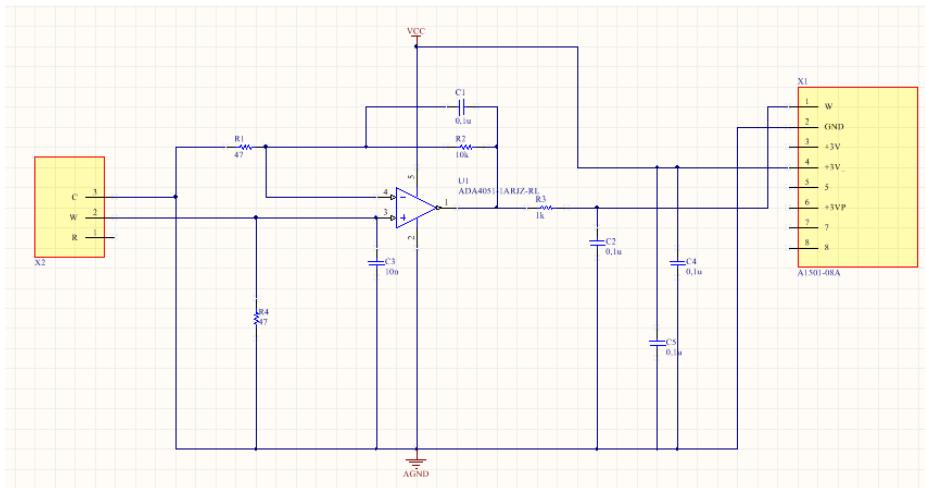
Для кислорода: при одной электрической схеме выпускается две платы. Они различаются только наличием выреза с разных сторон платы (Необходимо для прибора Бином-2В).
