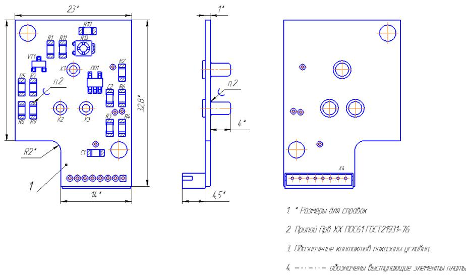
**Схема 13. Электрическая схема платы CO2-M**
