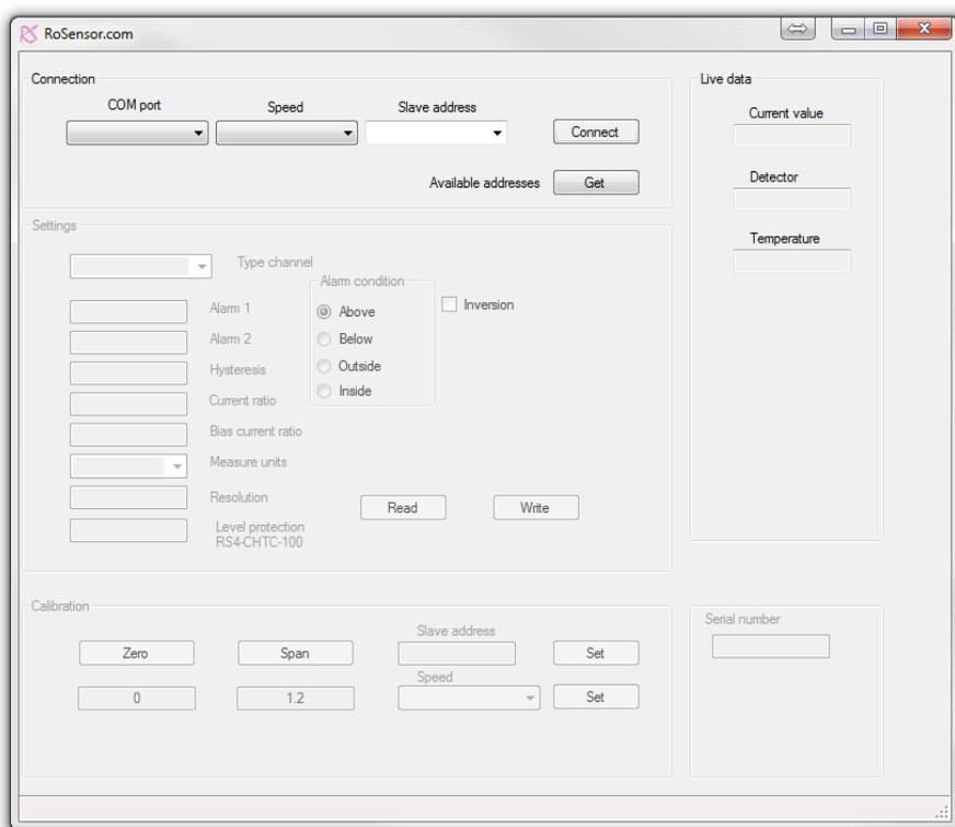
2. Slave адрес прибора по умолчанию 17, скорость 115200. COM порт нужно выбрать в соответствии с подключением преобразователя интерфейсов. Если адрес неизвестен, то при нажатии кнопки Get в выпадающем меню адреса газоанализатора отобразятся все доступные приборы для указанной скорости соединения (время опроса всех адресов около 2 минут). При
