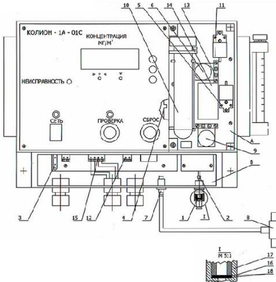
Рис. 5. Вид газового (А) и вводного (В) отделений БИ газоанализатора
