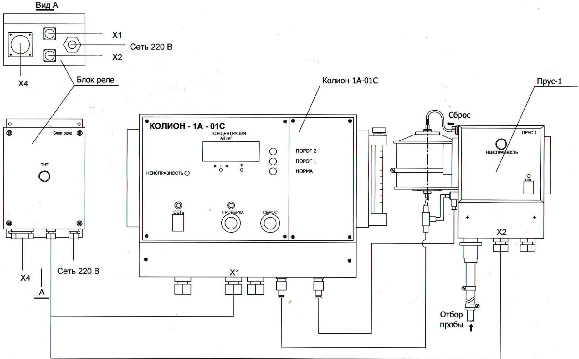
Рис. 2а. Схема соединения газоанализатора с блоком реле и устройством принудительной подачи пробы ПРУС-1
