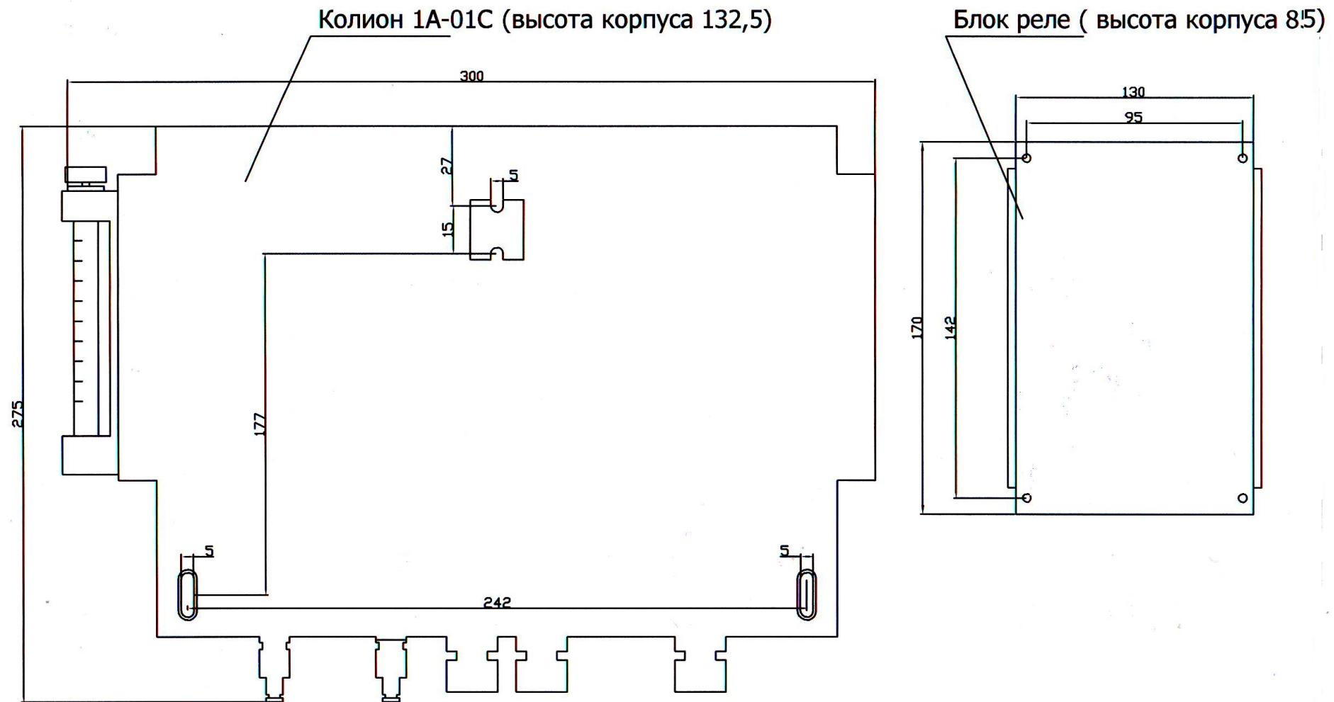
Рис. 26. Габаритные и установочные размеры газоанализатора
