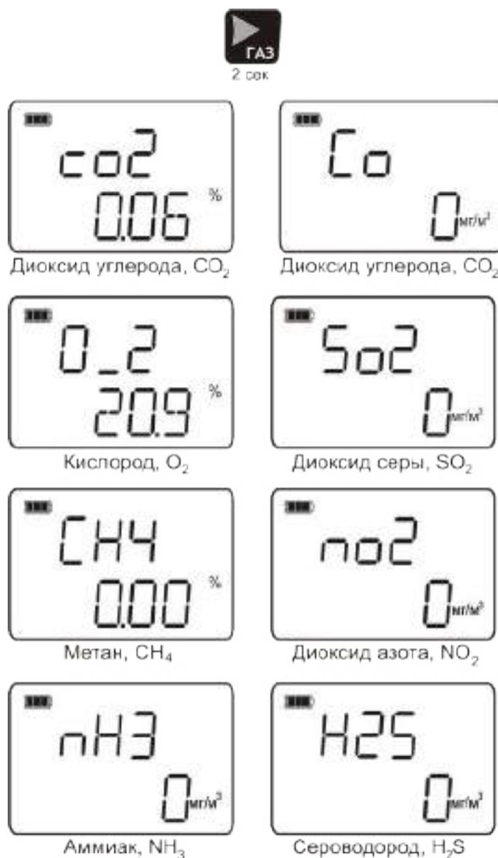
Рисунок 5.3 Схема режима РАБОТА
