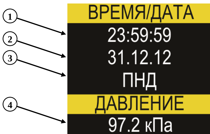
Рисунок 7. Дисплей в режиме "Дата и время"
