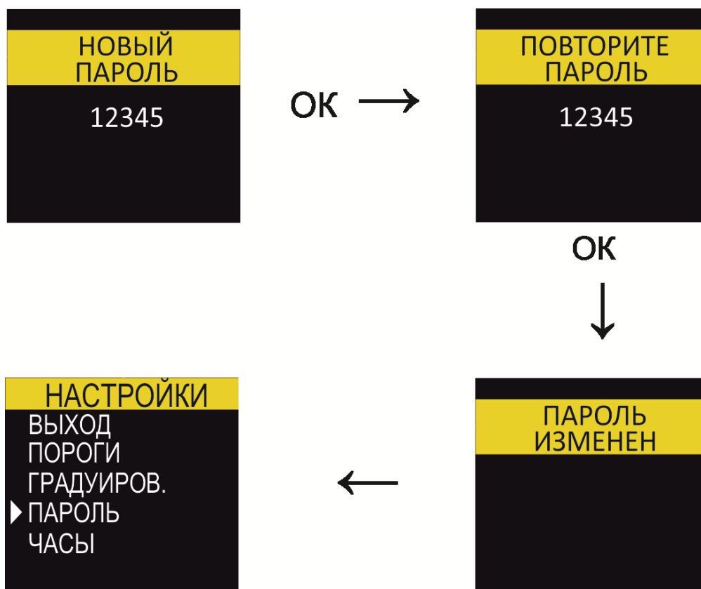
Рисунок 10. Дисплей в режиме "ПАРОЛЬ"
