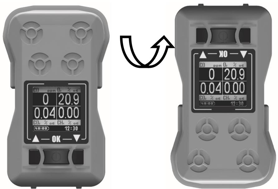
Рисунок 5. Автоматическая функция поворота изображения на дисплее
