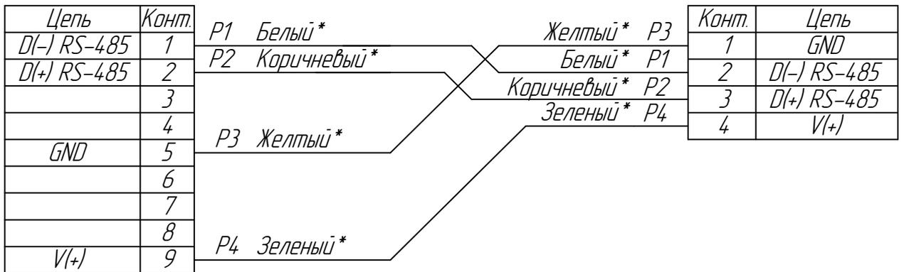
\* Примечание: цвета проводов даны для случая поставки кабеля LIYY 4 x 0.75 с завода-изготовителя
