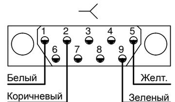
Тестовый кабель № ВЗ, кабель W10.1 ... W10.16 (Блок искрозащиты – БППН)
