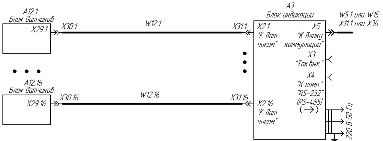
A12.1 ... A12.16 – Блоки датчиков исполнение И21(з) (БД)
