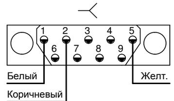
\* Примечание: цвета проводов даны для случая поставки кабеля LIYY 3 х 0.5 с завода-изготовителя
