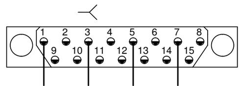
Примечание. После распайки разъемов X22.1 - X22.16 и X23.1 - X23.16 места пайки защищаются кембриком и внутренняя полость разъема заполняется изоляционным герметиком, например ABRO 1200.
