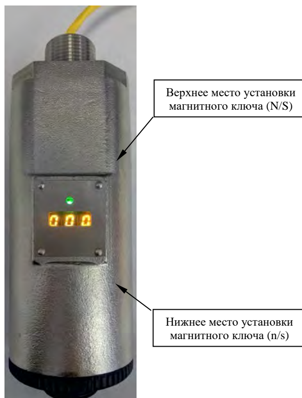
Рисунок 7 – Места установки магнитного ключа у ПГУ-А
