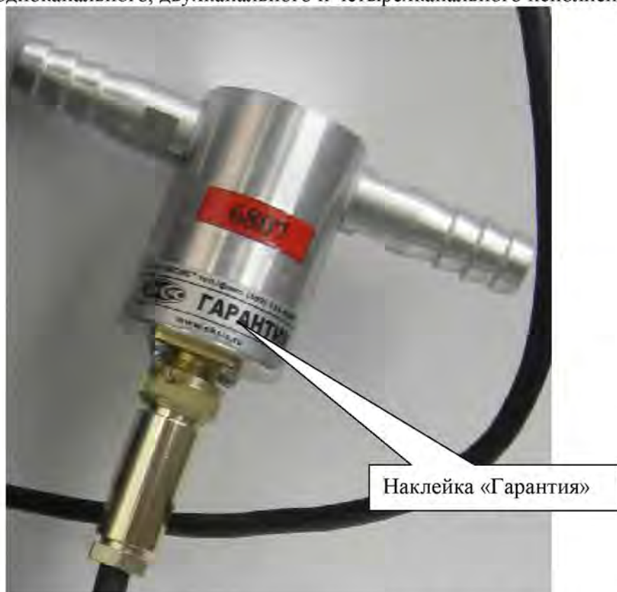
Рисунок 4 - Опломбировка выносного измерительного преобразователя газоанализатора ПКУ-4 Н
