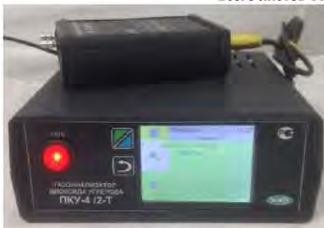
г) исполнение ПКУ-4 /2-Т (двухканальный, на фото показан только один измерительный преобразователь)
