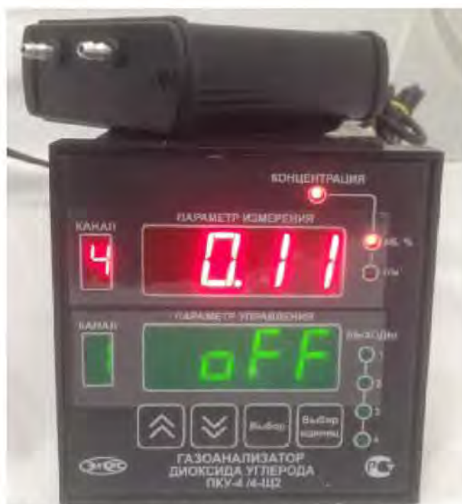
б) исполнение ПКУ-4 /4-Щ2 (четырёхканальный, на фото показан только один измерительный преобразователь)
