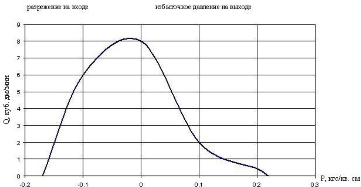
Рисунок 2.1 – Характеристика производительности побудителя расхода по воздуху
