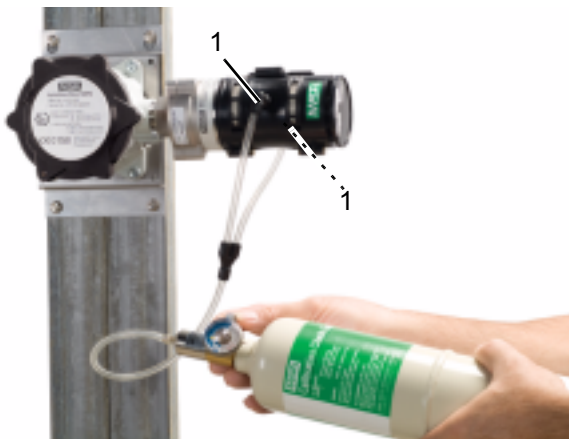
Рис. 15 Калибровка с помощью HART
