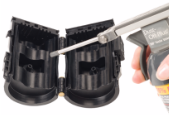
Рис. 20 Чистка защитной крышки
