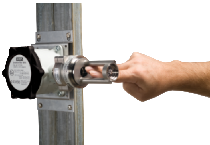
Рис. 19 Затемнение пути светового луча
