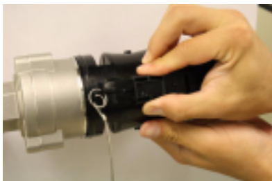
Рис. 18 Снятие защитной крышки
