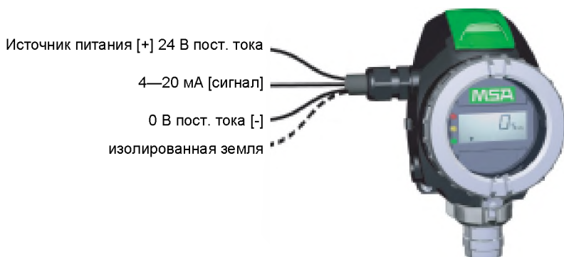
Рис. 5 3-проводное соединение — PrimaX P
