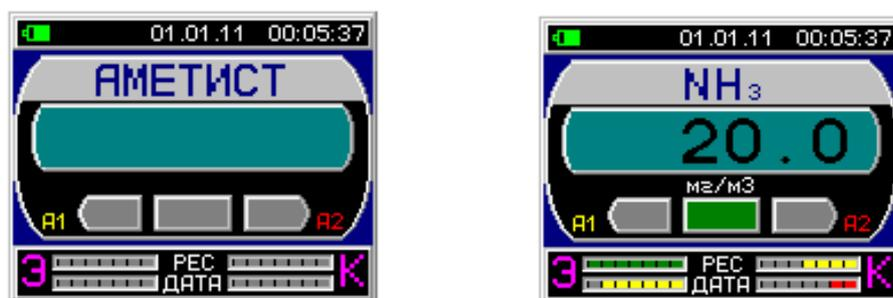
Рисунок 2.1 Вид дисплея газоанализатора в рабочем режиме
