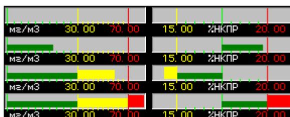
Рисунок 2.6 Вид дисплея газоанализатора в режиме линейной диаграммы
