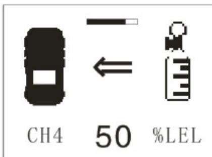
При наличии газа на входе прибор перейдет в режим калибровки данным газом, и на дисплее отобразится:
