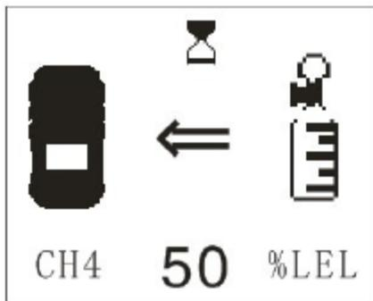
Если калибровка прошла успешно, на дисплее отобразится:
