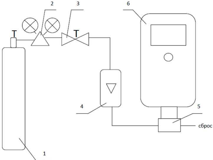
**Рекомендуемая схема подачи ГС из баллонов под давлением на вход газоанализатора**
