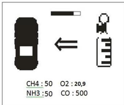
При наличии на входе прибора ПГС соответствующий газовый канал начнет автоматическую калибровку. По окончании калибровки ее результат будет показан следующим образом.
